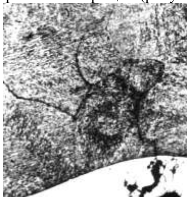
Рисунок 2 – Трещины в основном металле лемеха после термообработки по существующей технологии, \times 450
