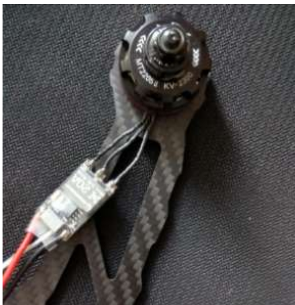
Рисунок 1 – Двигатель и регулятор оборотов закрепленный на раме
