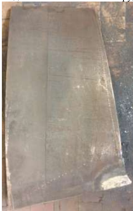
Фото 1 – Общий вид лопасти дымососа котельного оборудования, наплавленной способом сверхзвуковой газопорошковой наплавки
