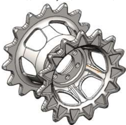
Рисунок 1 – Ведущее колесо гусеничного движителя
