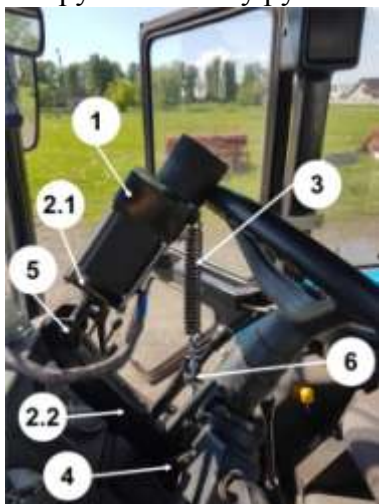
Рисунок 2 – Электродвигатель с системой крепления на рулевое колесо
