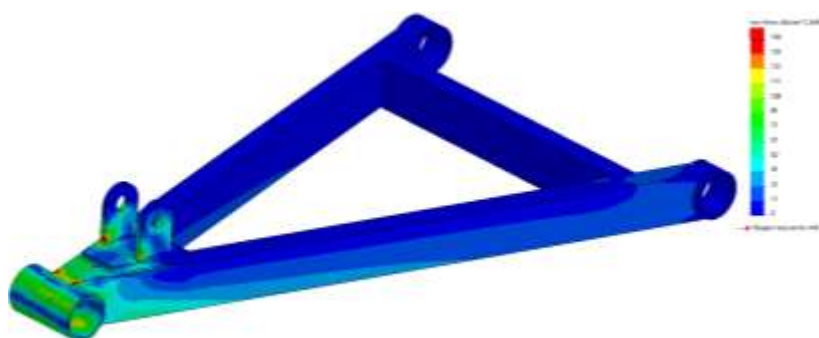
Рисунок 4 – Картина распределения эквивалентных напряжений
