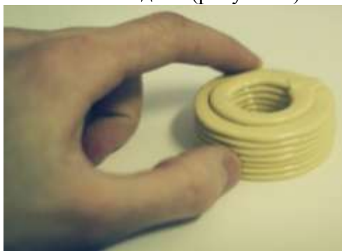
Рисунок 4 – Модель отпечатанная соплом диаметром 5мм.
