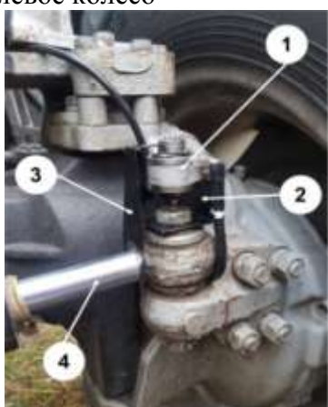
Рисунок 3 – Крепление датчика угла поворота и антенны GNSS-приемника
