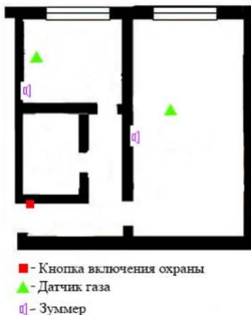
Рисунок 2 – Расположение датчиков модуля безопасности
