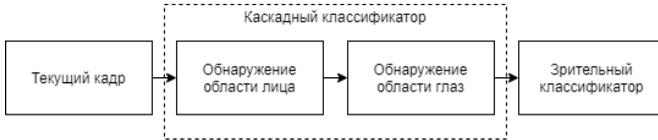
Рисунок 1 – Блок-схема алгоритма определения зрительной активности
