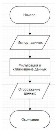
Рисунок 1 – Блок-схема работы программы в общем виде
