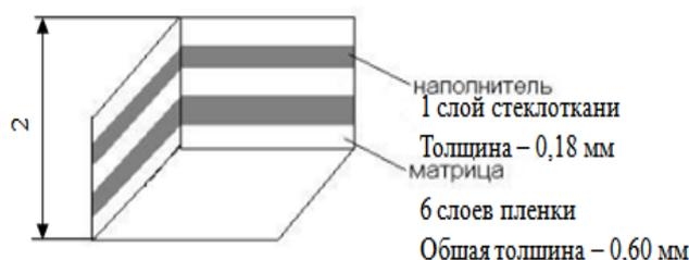
Рисунок 1 – Схема формирования образцов
