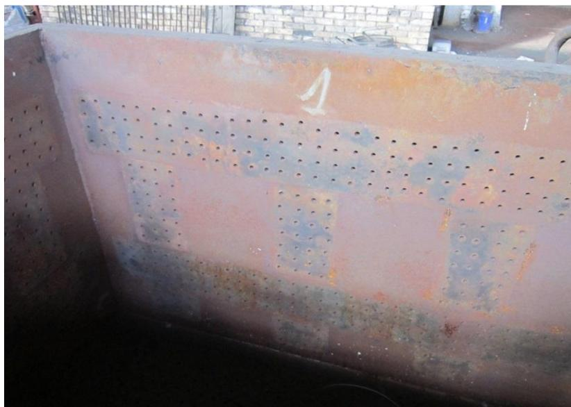
Рисунок 3 – Вакуумированная опока с боковым и нижним забором воздуха
