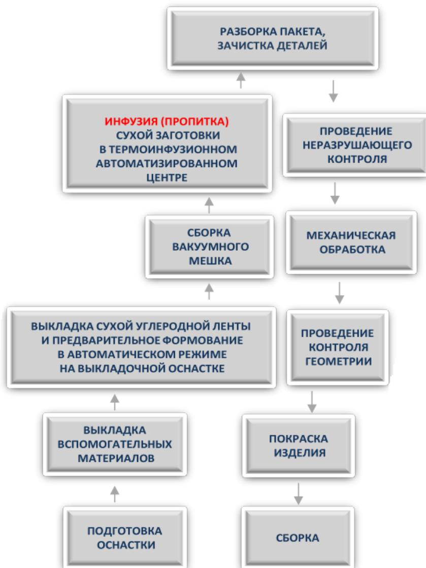
Рисунок 1 – Технологическая схема производства лонжеронов крыла самолета методом вакуумной инфузии
