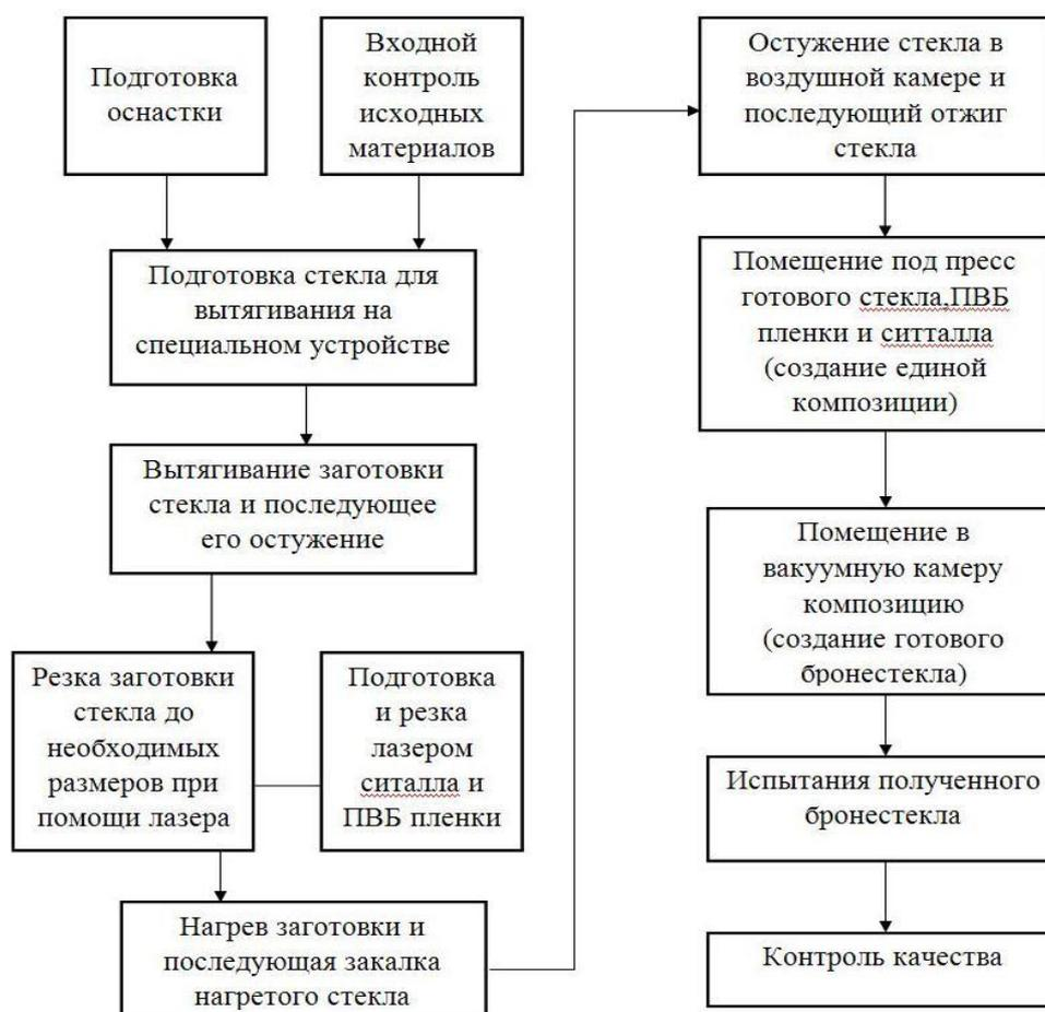
Рисунок 4 – Схема технологического процесса изготовления бронестекла
