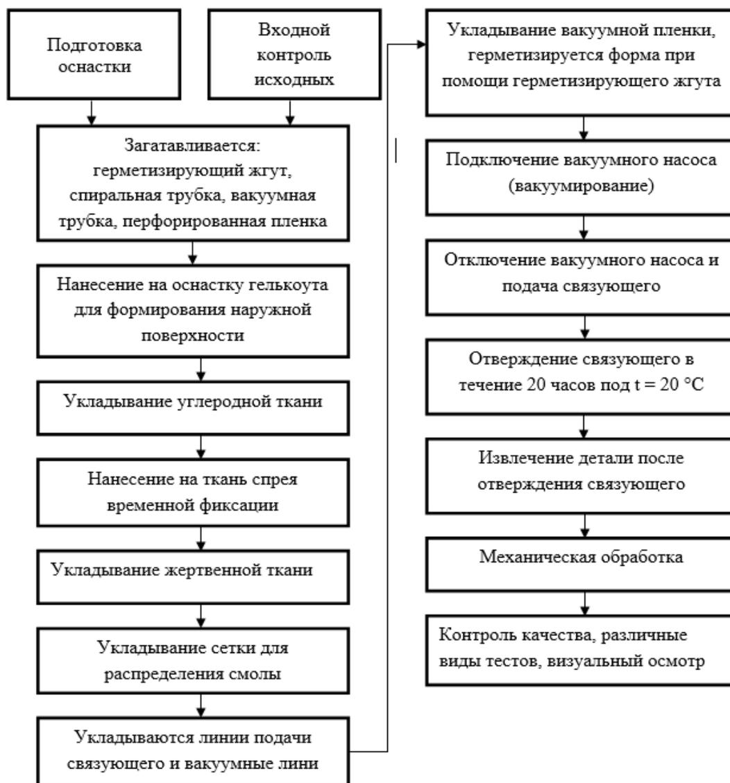
Рисунок 4 – Технологическая схема процесса
