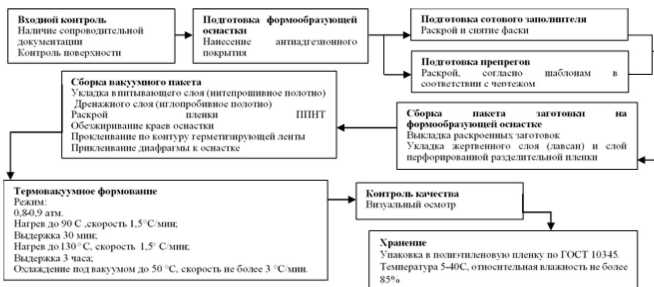
Рисунок 4 – Схема технологического процесса изготовления композитных сэндвич-панелей
