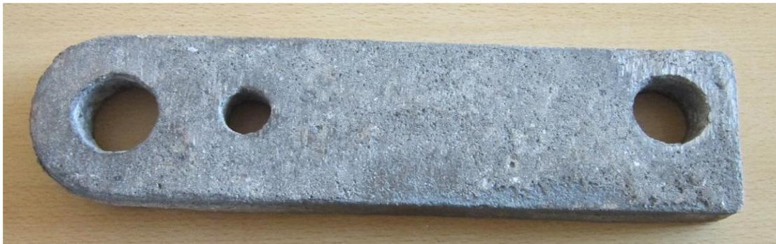
Рисунок 5 – Отливка, полученная с использованием опоки с гофрированным металлорукавом
