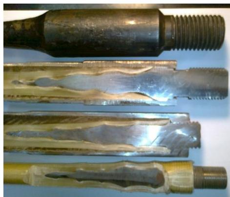
Рисунок 2 – Способы формирования адгезионного (клевого) соединения стали и однонаправленного стеклопластика в штангах погружного насоса, где а – общий вид элемента соединения; б – адгезионно-клеевое соединение, уплотняемое внешним клеевым составом; в – адгезионное соединение, уплотняемое резьбовой втулкой; г – прямое адгезионное соединение без стальной муфты
