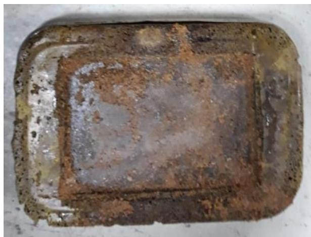
Рисунок 1 – Оболочковая форма при отсутствии содержания керосина в составе
