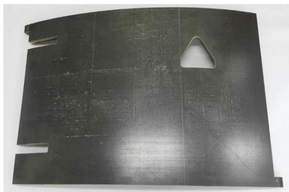
Рисунок 5 – Готовая створка мотогондолы
