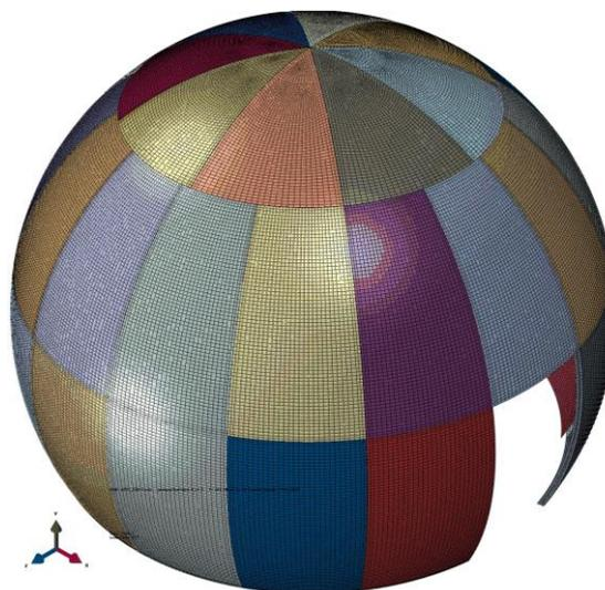
Рисунок 3 – Наружные композитные сэндвич-панели
