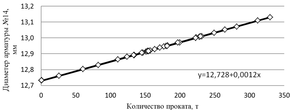
Рисунок 1 – Изменение диаметра арматуры № 14 в зависимости от количества проката на одном калибре валка
