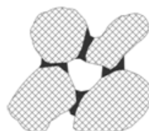
Рисунок 2- Расположение водных прослоек в слабоувлажненном грунте
