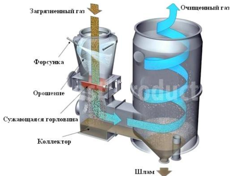
Рисунок 1 – Устройство газоочистки со скруббером Вентури
