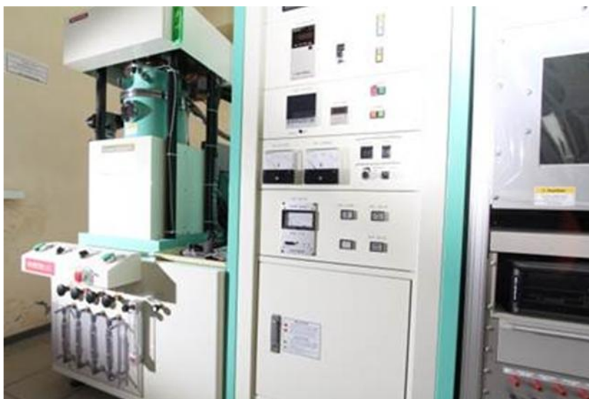
Рисунок 1 – Установка электроимпульсного плазменного спекания SPS-515S (Syntex Inc., Япония).
