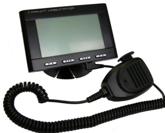
Рисунок 1 – Приемник ГЛОНАСС/GPS «Гранит-Навигатор.07» производства компании «Глобал Ориент» г. Москва
