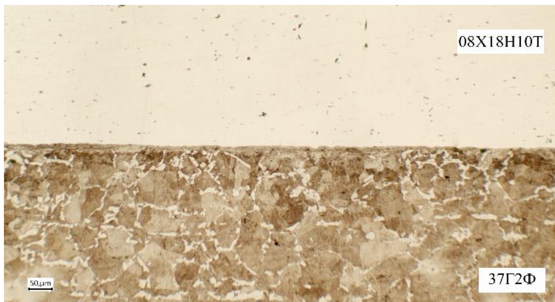
Рисунок 2 – Микроструктура границы соединения после сварки взрывом
