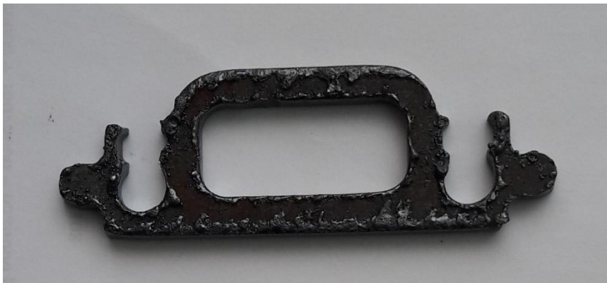
Рисунок 1 – Заготовка боковины измерительного устройства, вырезанная плазменной резкой
