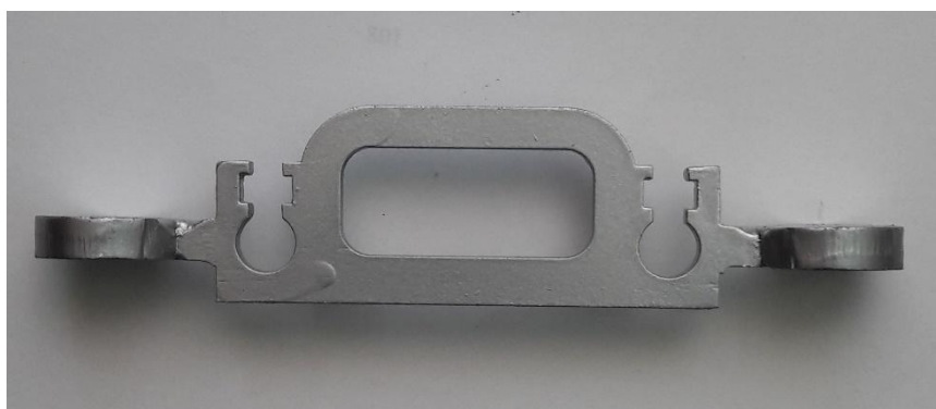
Рисунок 2 – Заготовка боковины измерительного устройства, вырезанная лазерной резкой с приваренными лапками
