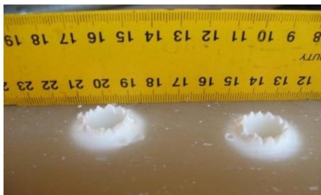
Рисунок 2 – Отпечатки, оставленные коническим индентором твердомера на парафиновом образце
