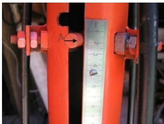
Рисунок 1 – Определение глубины погружения конического индентора по шкале мерной линейки твердомера при испытаниях на парафиновой пробе
