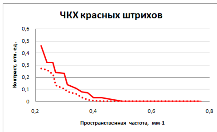
Рисунок 5 – ЧКХ видеокамер смартфонов: Honor8 – сплошная линия; Samsung Galaxy A50 – точечная линия
