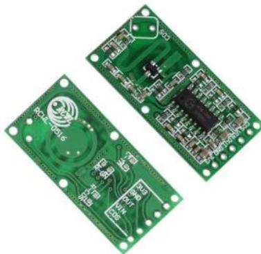
Рисунок 1 – Микроволновый датчик движения RCWL-0516 [1]
