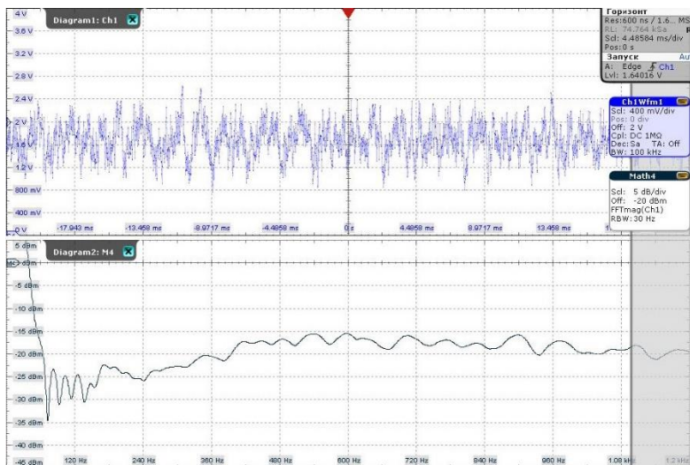
Рисунок 4 – Осциллограмма и спектрограмма генерируемого сигнала нормально распределенной случайной величины
