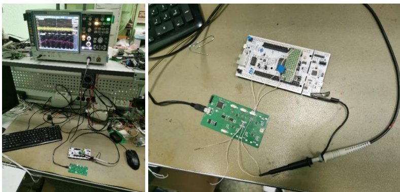
Рисунок 3 – Стенд генерации, сигнал нормально распределенной случайной величины с подключенной платой прототипа
