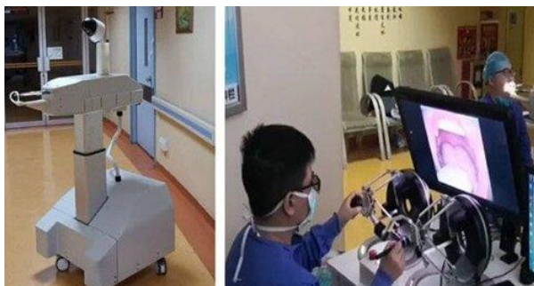
Рисунок 2 – Роботизированная механическая рука для взятия мазка из горла потенциально заболевшего пациента
