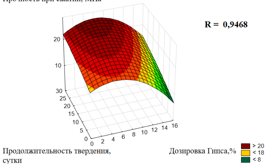
Рисунок 2 – Зависимость прочности при сжатии составов с введением гипса от продолжительности твердения после ТВО (хранение в нормальных условиях, с последующим хранением на морозе и далее в воздушно-комнатных условиях)
