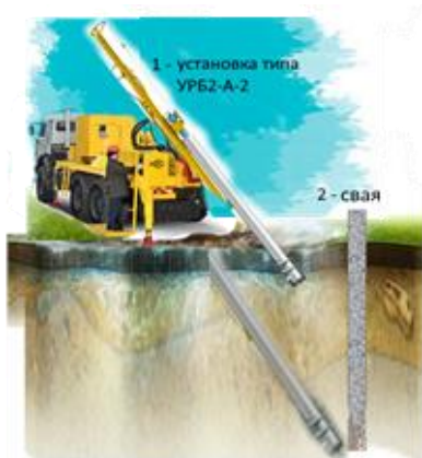
Рисунок 2 – Схема бурения установкой типа УРБ2-А-2
