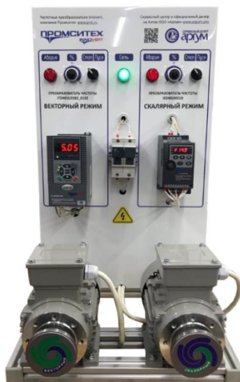
Рисунок 1. Лабораторный стенд «Исследования скалярного и векторного режимов частотного управления асинхронным электроприводом»
