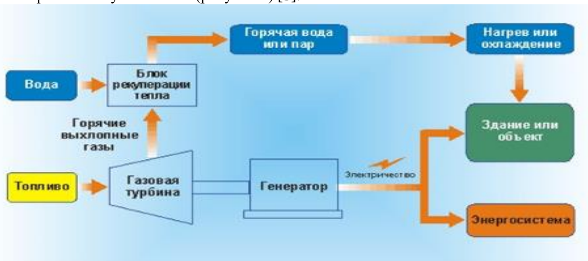
Рисунок 1 - Схема когенерационной системы
