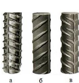
Рисунок 1 – Типы периодического профиля арматуры, выпускаемой в РФ
