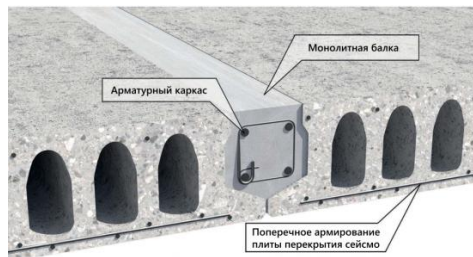
Рисунок 4 – Продольный стык плит перекрытия
