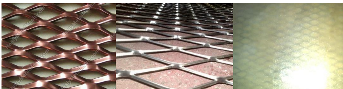
Рисунок 3 – Просечно-вытяжные металлические сетки различного типа (а, б) и стеклопластик, армированный сеткой (в)
