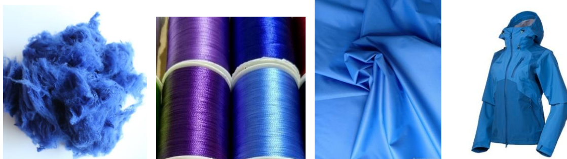
Рисунок 5 – Этапы изготовления мембранной ткани для спортивной одежды
