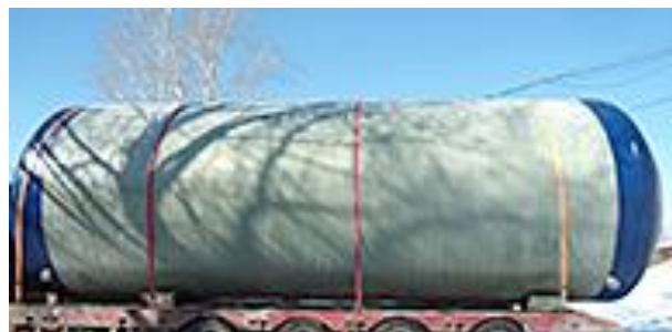
Рисунок 1 – Закрепление емкости на автомобильной платформе для транспортировки
