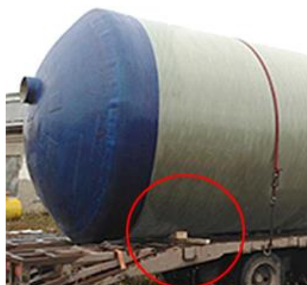
Рисунок 2 – Закрепление емкости на автомобильной платформе при помощи клиньев для транспортировки
