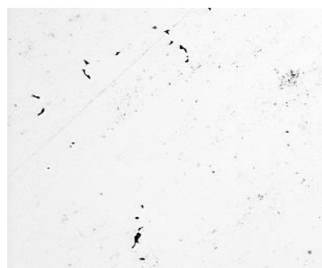
Рисунок 2 – Наличие пористости в структуре, где a – песчано-глинистая форма; б – ЛГМ (×500)
