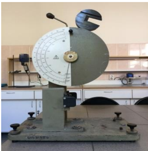
Рисунок 6 – Маятниковый копёр для испытания полимерных композиционных материалов на ударную вязкость
