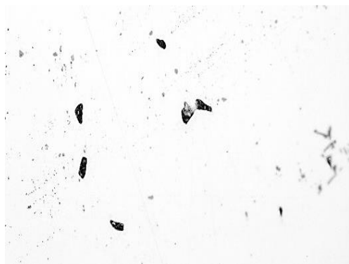
Рисунок 2 – Наличие пористости в структуре, где a – песчано-глинистая форма; б – ЛГМ (×500)
