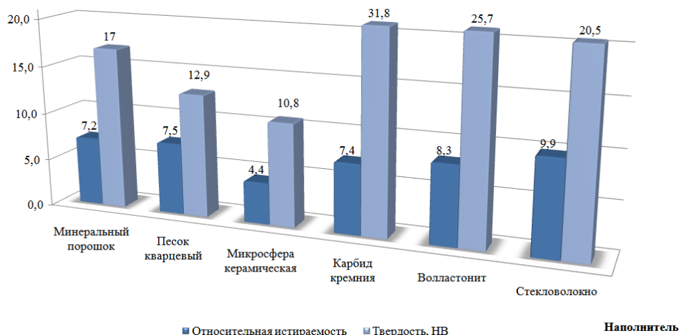
Рисунок 3 – Относительная истираемость и твердость образцов дисперсно-наполненных композитов
