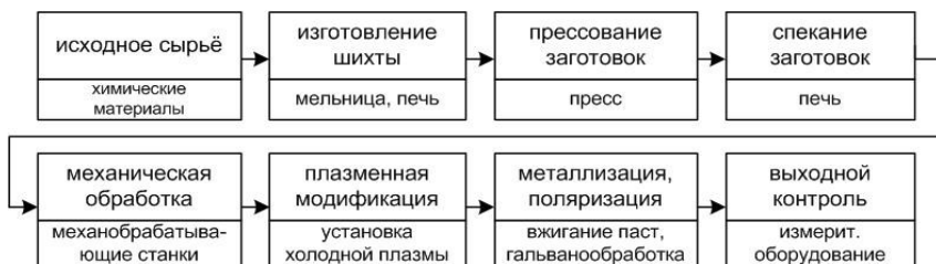
Рисунок 1—Укрупнённая структурная схема технологического процесса производства пьезокерамических элементов.
