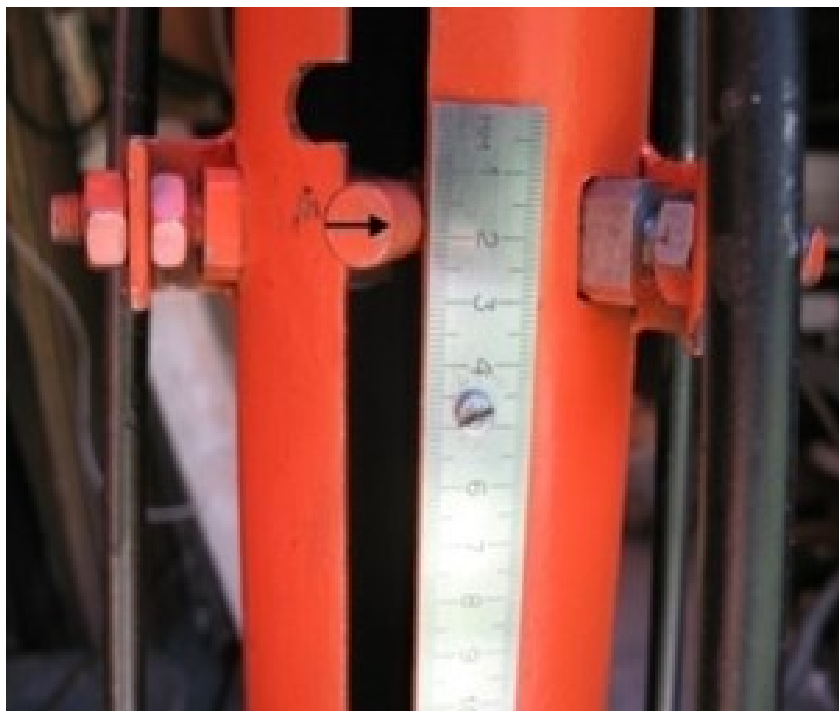
Рисунок 3 – Определение глубины погружения конического индентора в испытуемую среду по шкале мерной линейки твердомера
