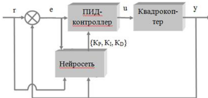
Рисунок 1 – Структурная схема управления ПИД–регулятором, содержащая нейросеть
