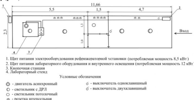
Рисунок – Объемно-планировочное решение лабораторного помещения и схема расположения в нем необходимого электрооборудования
