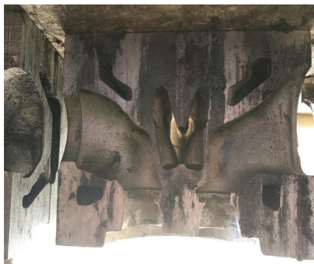
Рисунок 6 - Полученная геометрия внутренней полости головки блока в отливке
