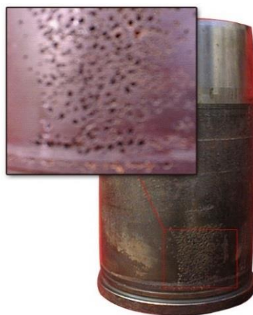
Рисунок 1 – Гильза цилиндра дизельного двигателя, подвергшаяся воздействию кавитационной эрозии
