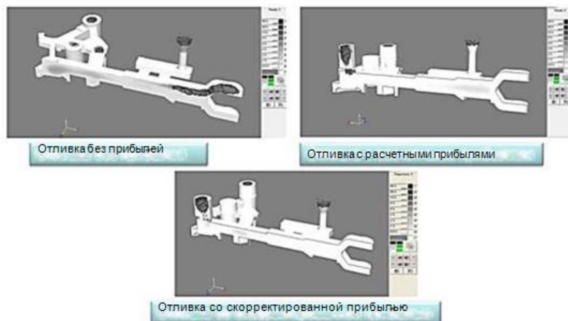
Рисунок 2 – Результаты моделирования усадочных процессов
