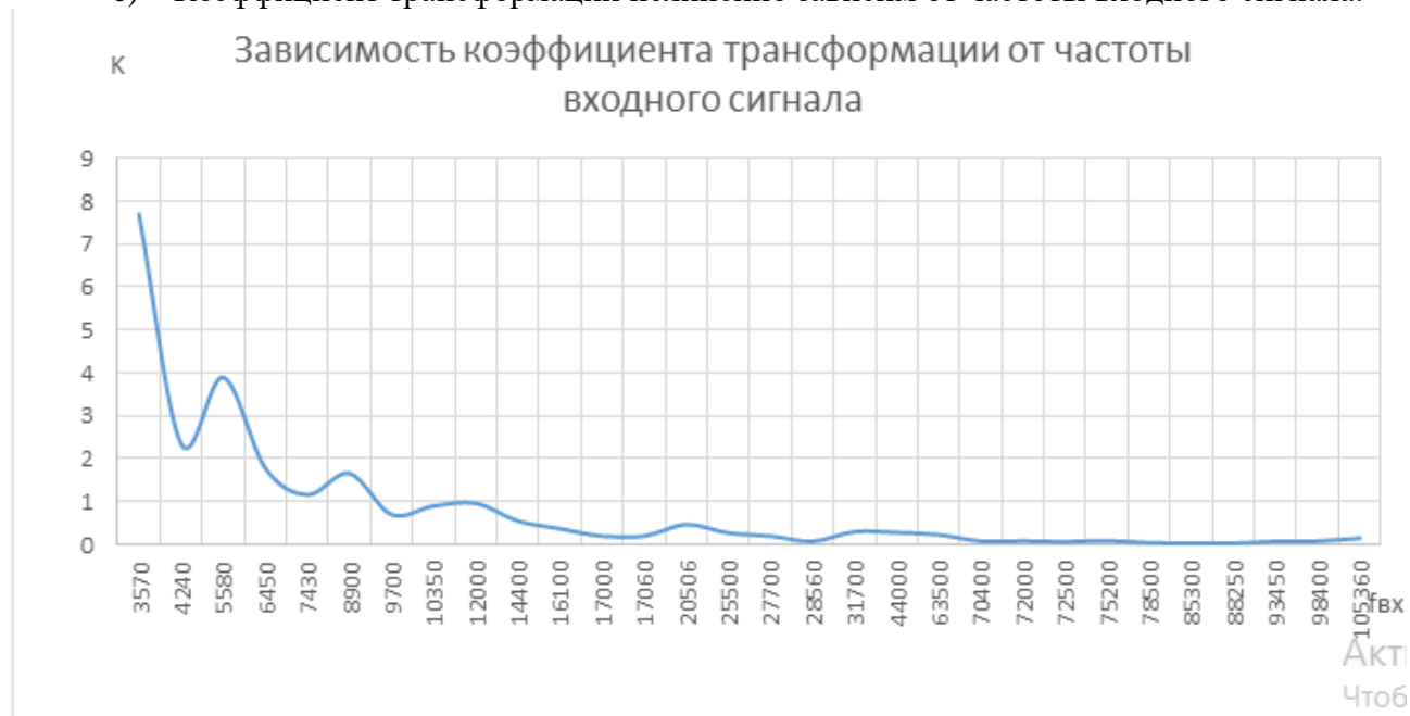
Рисунок 2 – График зависимости коэффициента трансформации от частоты входного сигнала
