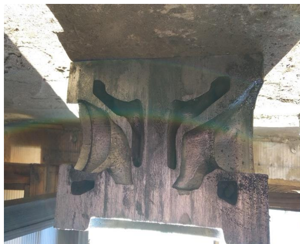
Рисунок 4 - Полученная геометрия внутренней полости головки блока в отливке
