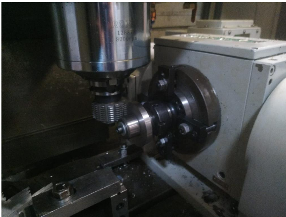
Рисунок 1 – Пример технологической наладки для зубофрезерной операции на 5-координатном станке VMC-750
