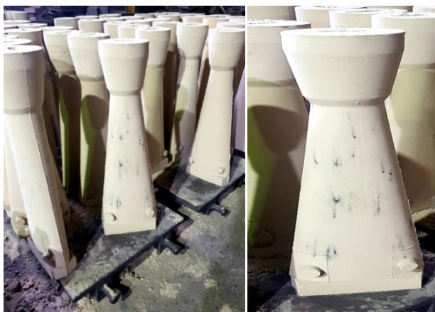
Рисунок 1 – Крупные стержни с арматурой
