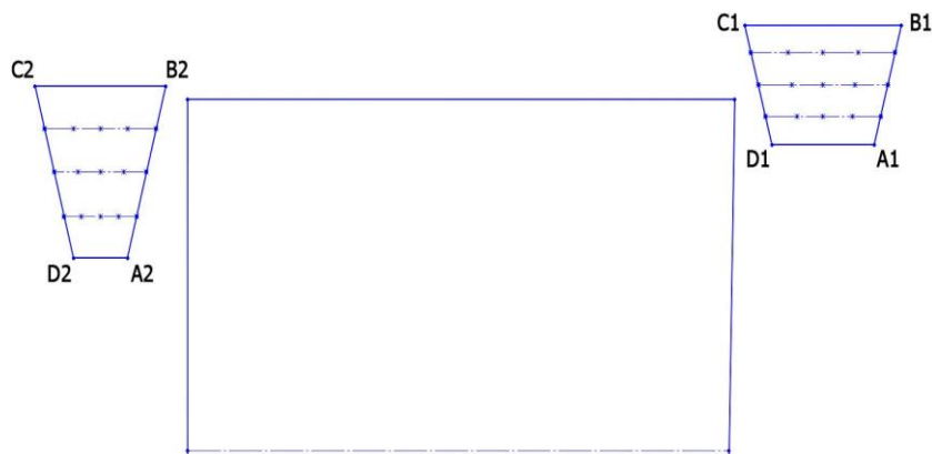
Рисунок 1 - Исходная и конечная форма профиля канавки шнека в виде трапеций
