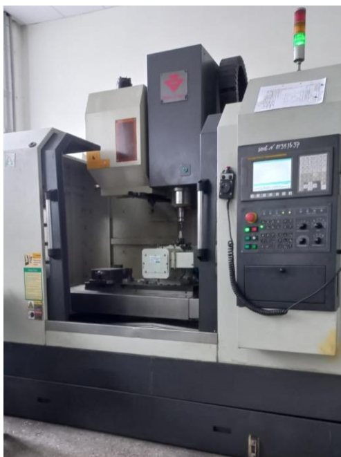
Рисунок 2 – Пример фрезерного 5-координатного станка
