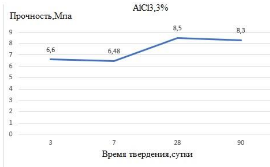
Рисунок 3 – Зависимость прочности материала от дозировки добавки AlCl 3 и времени твердения
