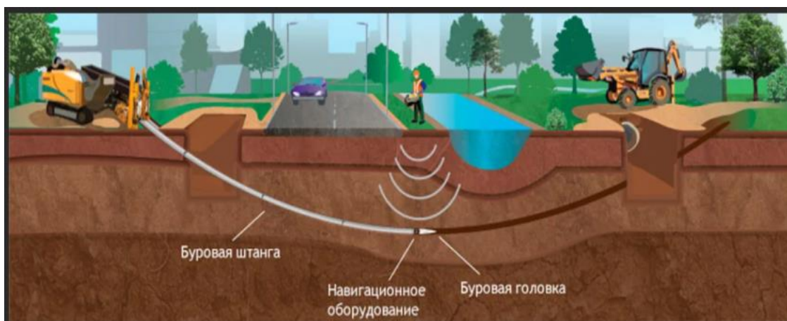
Рисунок 2 – Прокладка бестраншейным способом
