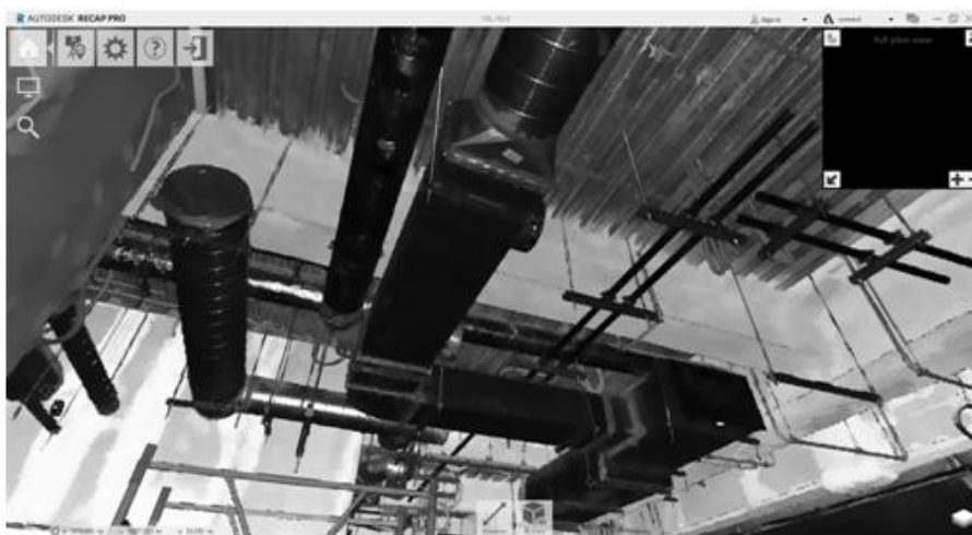
Рисунок 1 – Фрагмент облака точек в программном комплексе ReCap
