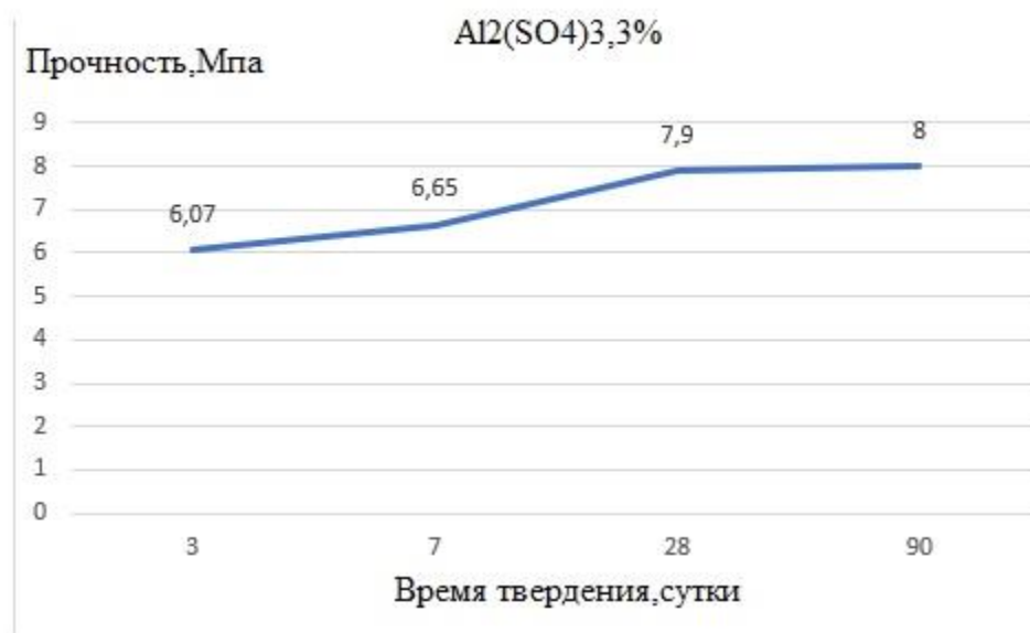
Рисунок 2 – Зависимость прочности материала от дозировки добавки Al 2 (SO 4 ) 3 и времени твердения
