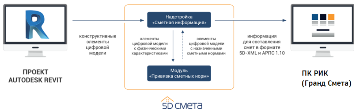
Рисунок 1 – Схема взаимодействия Revit и 5D смета.
