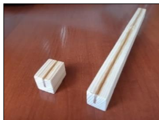
Рисунок 1 – Образцы, усиленные полимерным составом
