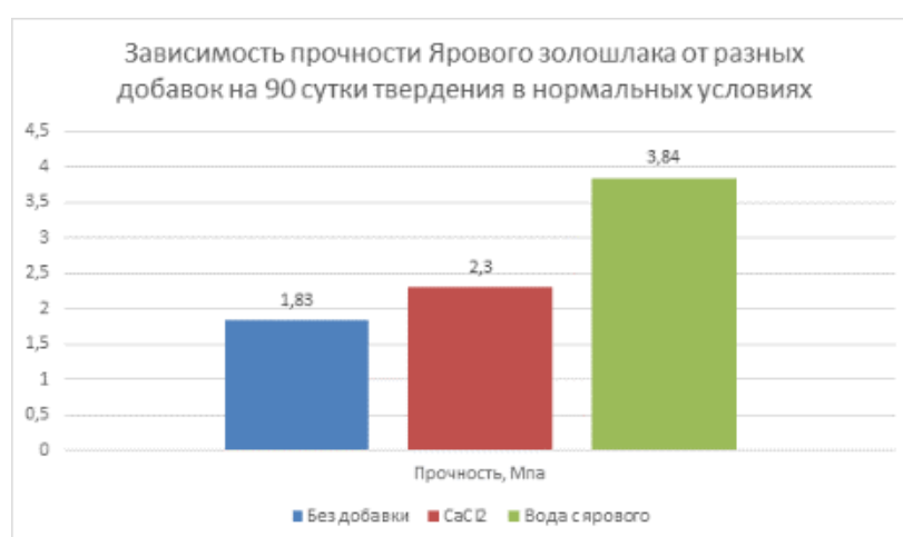
Рисунок 5 – Зависимость прочности материала, который заформован полусухим методом, из Ярового золошлака от разных добавок на 90 сутки твердения в нормальных условиях
