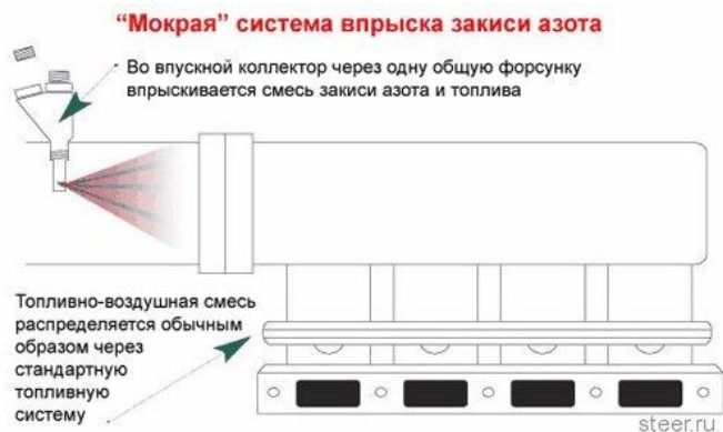
Рисунок 2 – «Мокрая» система закиси азота
