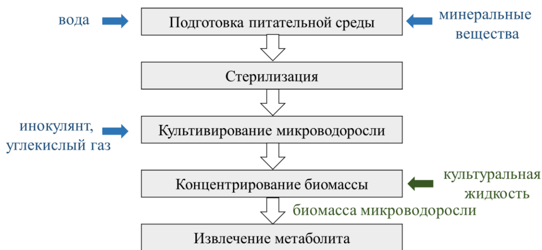
Рисунок 1 – Процессуальная схема культивирования микроводорослей
