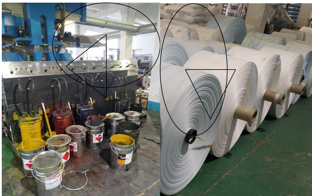
Рисунок 2 – Процесс многоцветной печати на полипропиленовых рулонах мешковой ткани
