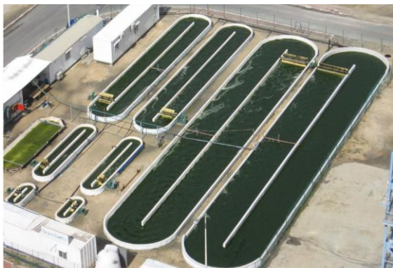
Рисунок 2 – Пример конструкции открытого типа (открытый пруд)
