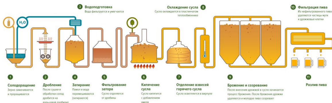
Рисунок 2 – Технологическая схема производства пива светлого
