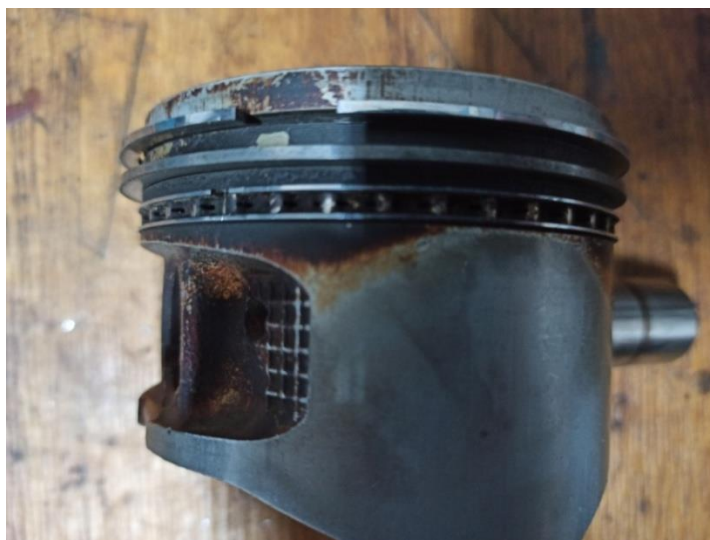
Рисунок 2 – Закоксованный верхний и нижний маслоъемный скребок
