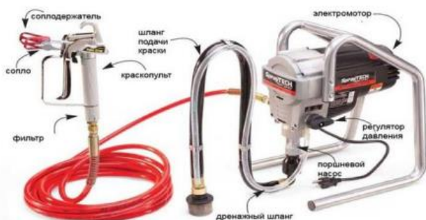
Рисунок 3 – Оборудование для безвоздушной покраски
