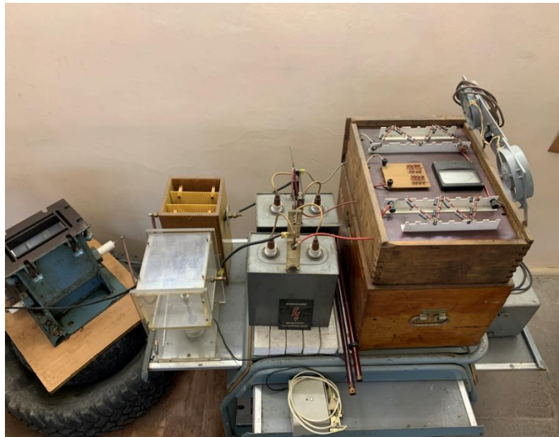
Рисунок 3 – Экспериментальная установка для приготовления коллоидного раствора воды с дизельным топливом [4]
