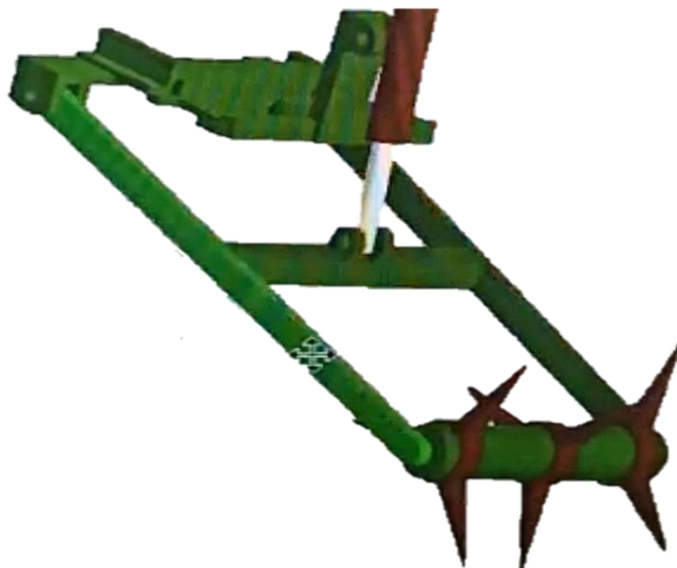
Рисунок 1 - Фронтальный прокалыватель-щелерез (патент на изобретение № 2769449) [5]
