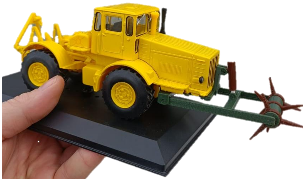
Рисунок 5 – Изготовление модели полурампного трактора К700 с установленным фронтальным прокальвателем-щелерезом методом 3D-принтирования
