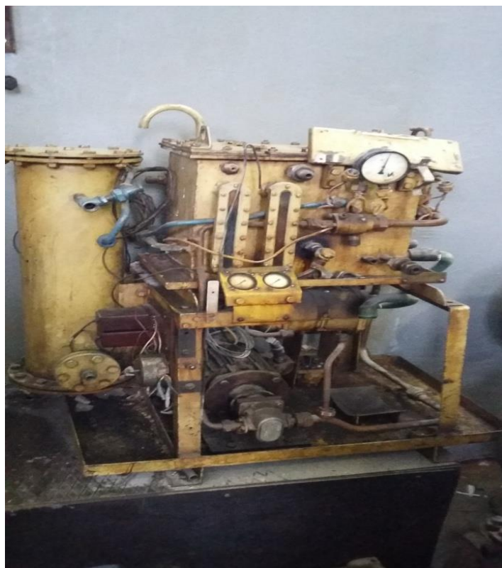
Рисунок 1 – Серийно изготавливаемая установка ВТЭ – 3 для приготовления грубой ВТЭ тяжёлое топливо+вода. Установка успешно эксплуатировалась на судах Западно-Сибирского пароходства [1]
