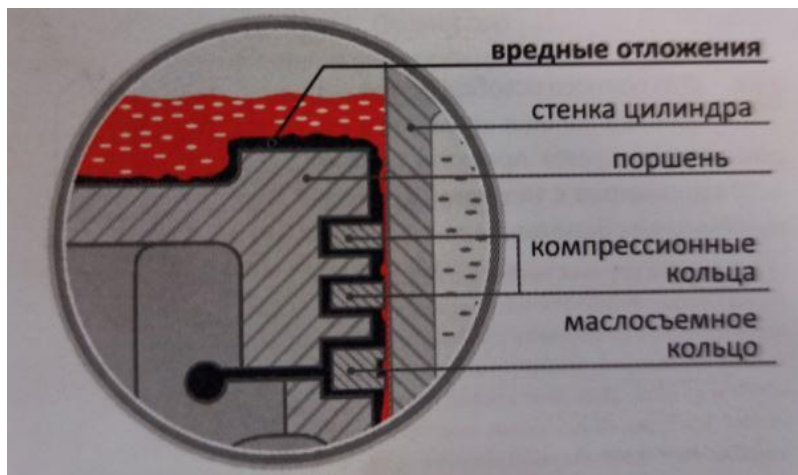
Рисунок 1 – Места вредных отложений на поршне
