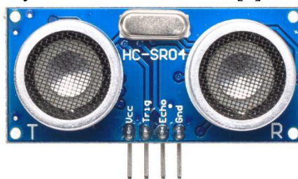
Рисунок 1 – Ультразвуковой датчик расстояния HC-SR04 [1]
