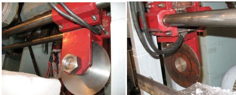
Рисунок 1 – Тензометрический элемент, установленный на лабораторном стенде: а – в сборе с П – образным кронштейном и режущим инструментом; б – в сборе с Г – образным кронштейном и режущим инструментом
