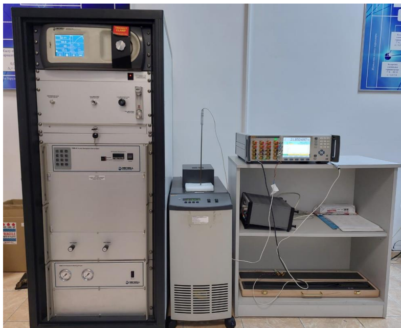
Рисунок 4 – Система калибровки точки росы DCS80, термостат Fluke 7380, эталонный термометр ЭТС-100 и супер-термометр Fluke 1594
