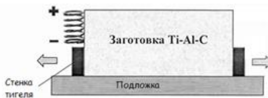
Рисунок 3 – Процесс протекания СВЧ-спекания
