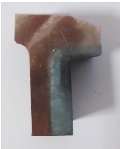
Рисунок 1 - Микрошлиф образца чугуна ЧХ28
