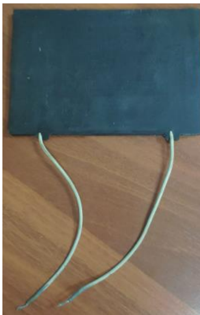
Рисунок 2 – Наноструктурный композиционный резиновый электрообогреватель
