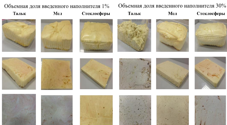
Рисунок 1 – Образцы пенополиуретана с 1% и 30% объемной долей наполнителей (тальк, мел, стеклошеры)
