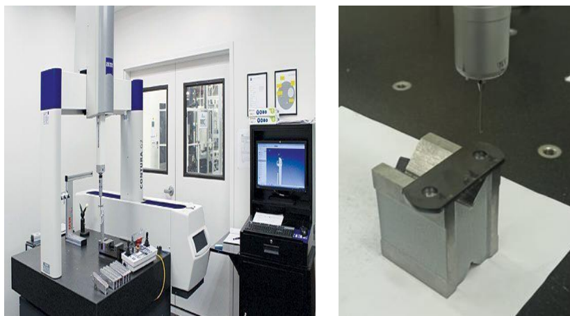
Рисунок 3 – Измерение межосевого расстояния
