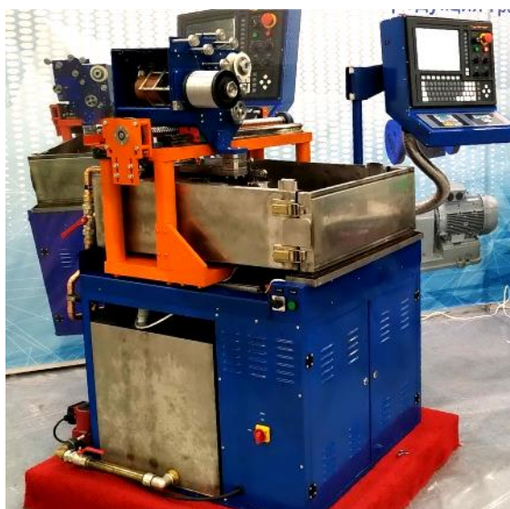
Рисунок 2 - Электроэрозионный проволочно-вырезной станок погружного типа «Искра-1В ММЗ» производства АО «Марийский машиностроительный завод»
