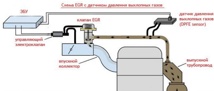
Рисунок 2 – Система EGR с датчиком давления выхлопных газов
