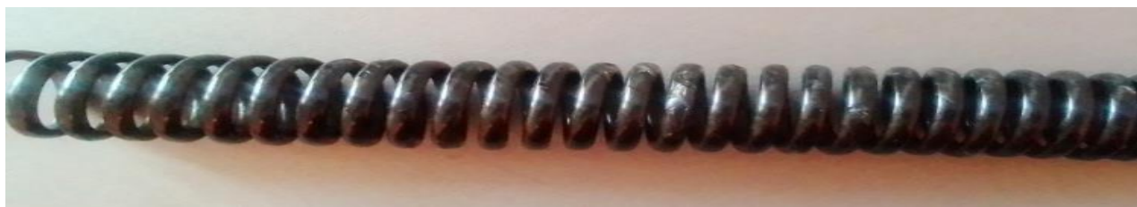
Рисунок 2 – Пружина растяжения из углеродных волокон УКН-5000
