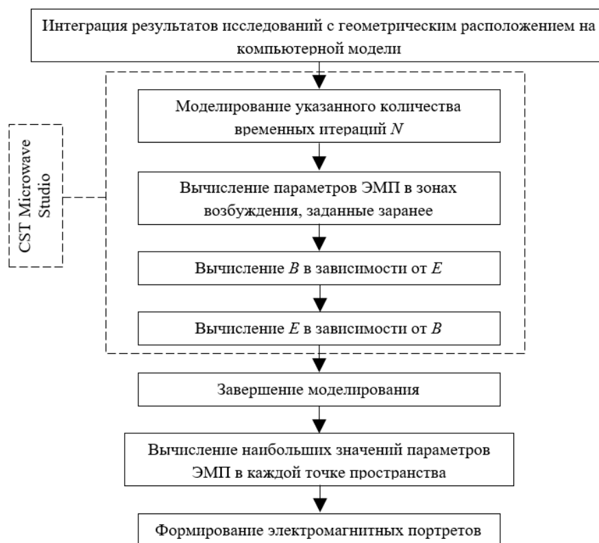
Рисунок 1 – Блок-схема моделирования электромагнитной обстановки методом конечного интегрирования
