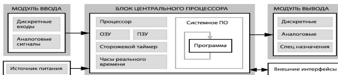
Рисунок 1 – Структурная схема программируемого логического контроллера
