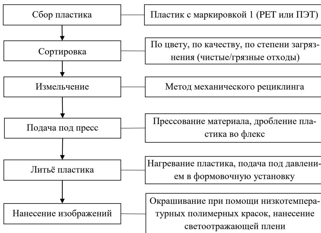
Рисунок 1 –Технология производства дорожных знаков с применением переработанного пластика
