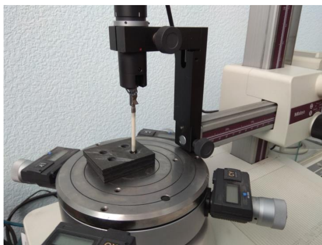
Рисунок 2 – Измерение отклонения от круглости профиля отверстия в детали из углепластика.
