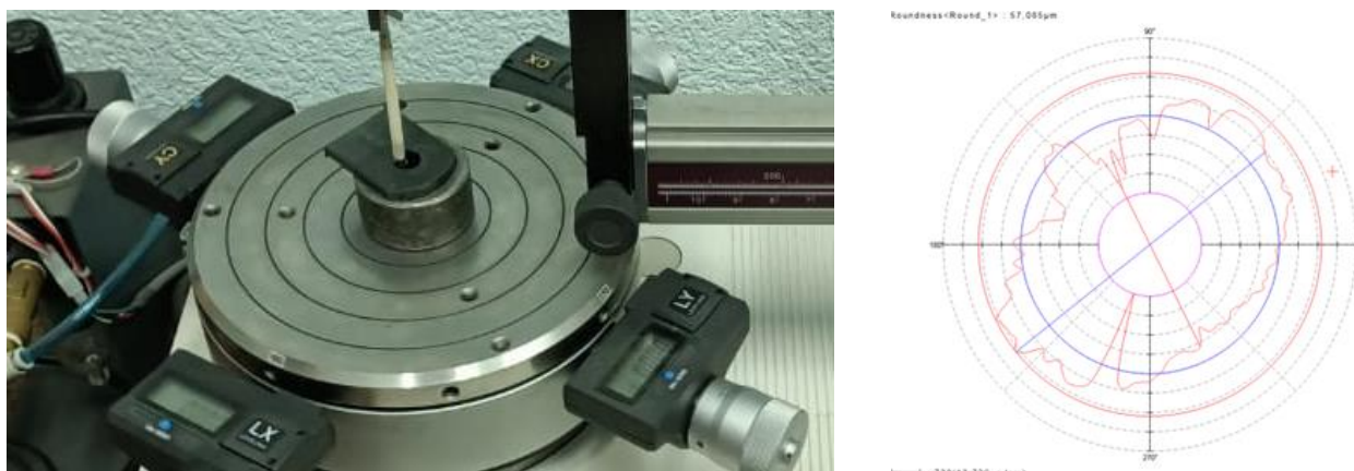
Рисунок 4 – Измерение отклонения от круглости
