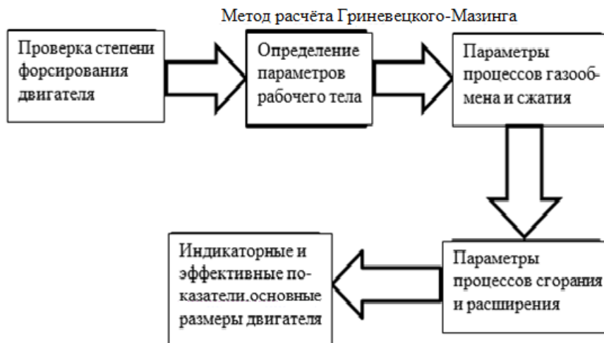
Рисунок 1 - Блок-схема теплового расчета
