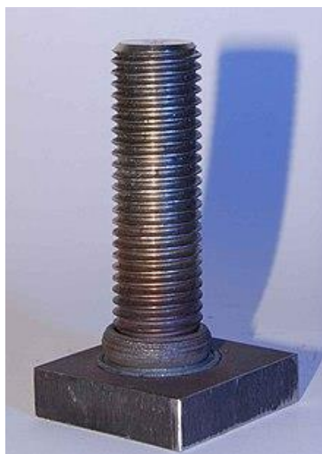
Рисунок 1 - Соединение, полученное сваркой трением
