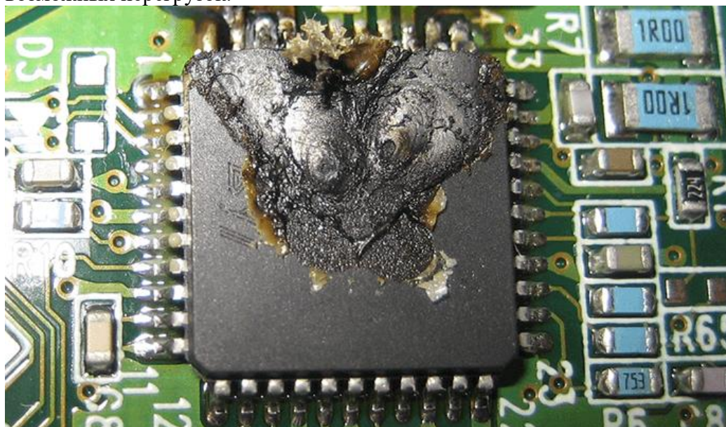
Рисунок 10 – Выгоревшая микросхема на плате
