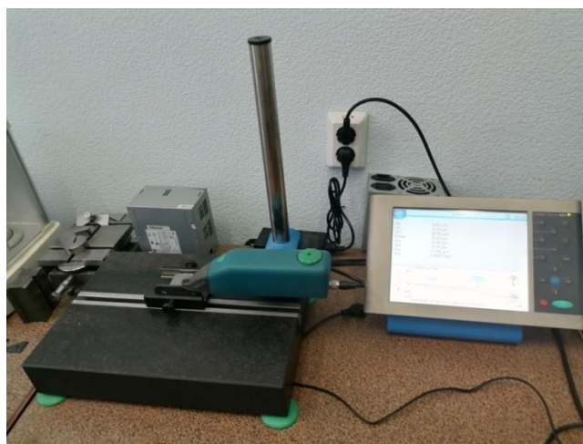
Рисунок 5 – Измерение шероховатости реза
