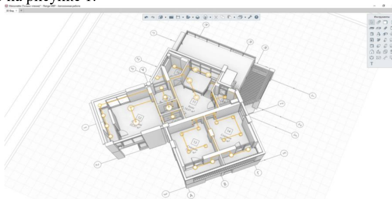
Рисунок 2 – Построение трасс электрических систем в Renga
