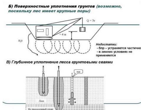
Рисунок 2 - Поверхностное и глубинное уплотнение лёссовых грунтов
