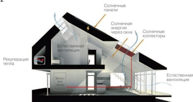
Рисунок 1 – 1- 3D-модель «Активного дома»; 2- разрез «Активного дома» с указанием основных технических решений.
