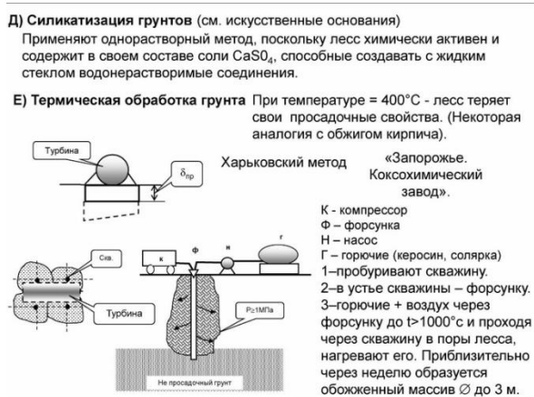
Рисунок 3 - Силикатизация грунтов и термическая обработка
