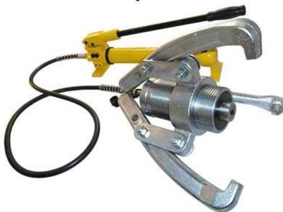
Рисунок 1 – Специальное устройство для выпрессовки и запрессовки валов и подшипников
