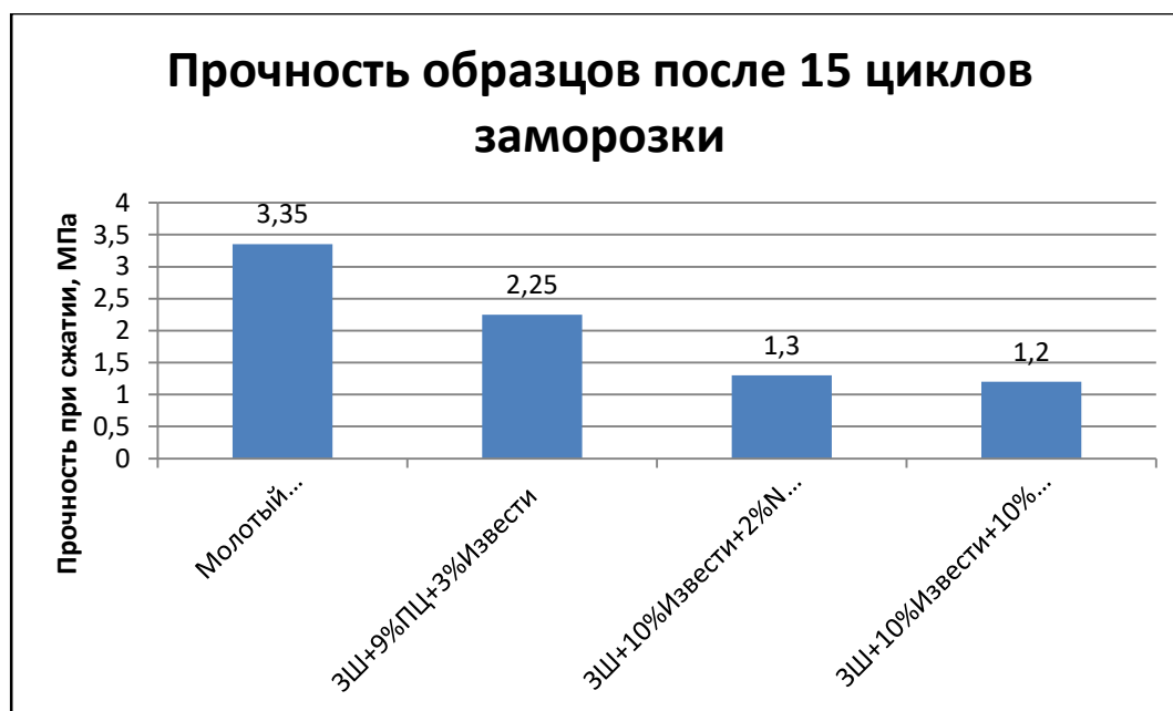
Рисунок 2 - Прочность при сжатии образцов после заморозки
