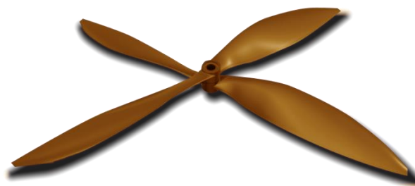
Рисунок 1 – Пропеллер, изготовленный из композиционных материалов.
