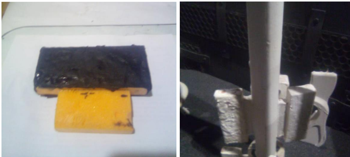
Рисунок 2 – Этапы подготовки модели из пенополистирола к заливке: а – нанесение легирующего состава на модель, б – готовый блок
