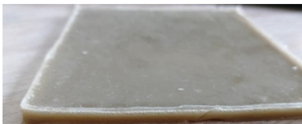
Рисунок 3 – Образец гибридного композиционного материала на основе минерального и эпоксидного связующих, армированных силикатными частицами
