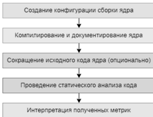
Рисунок 2 – Последовательность операций для измерения сложности кода ядра
