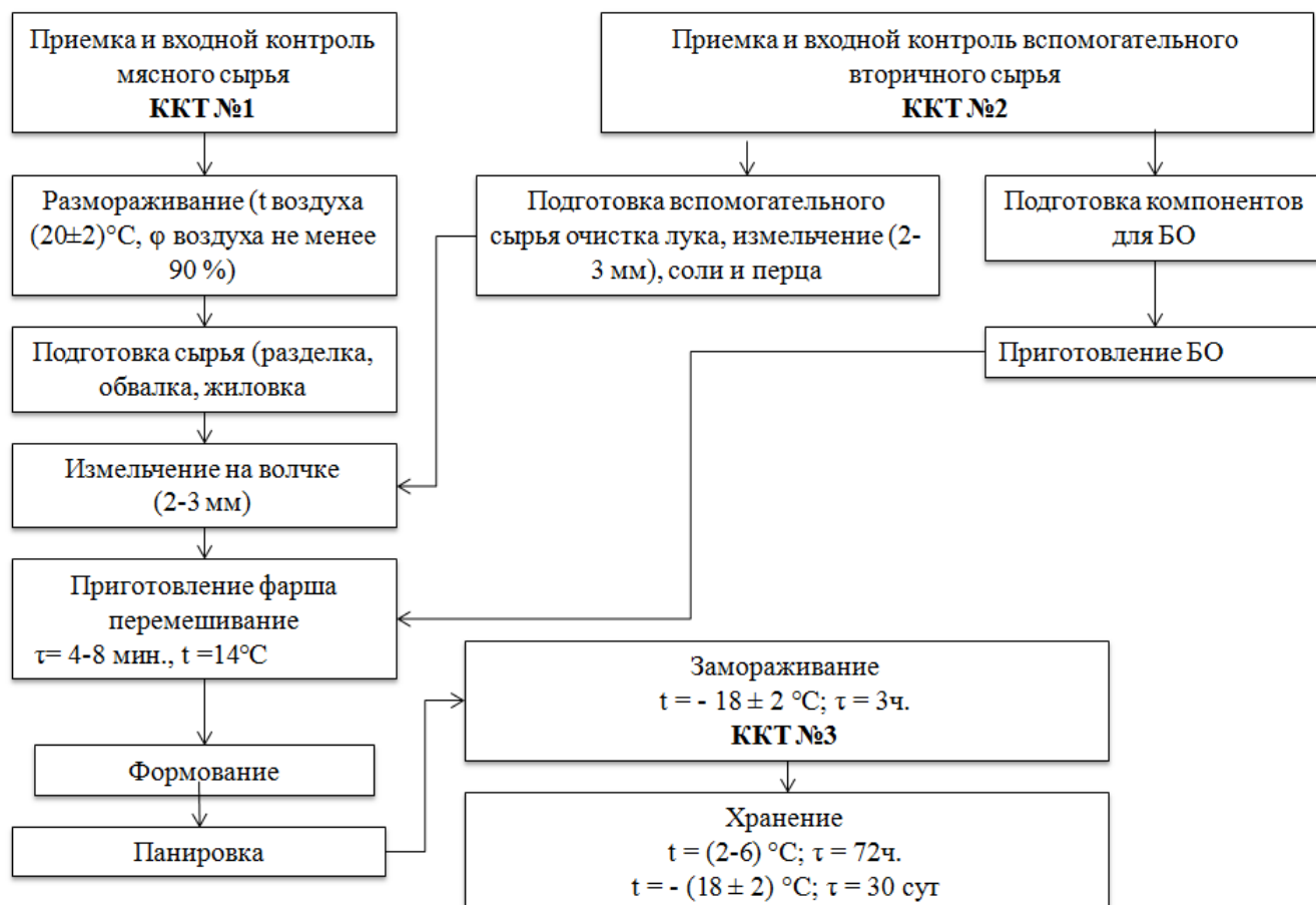
Рисунок 1 – Блок-схема производства мясного полуфабриката
