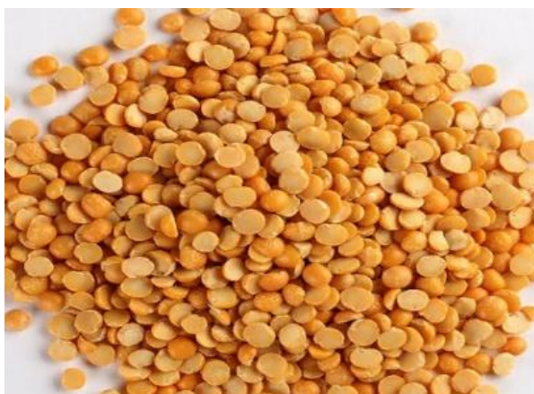
Рисунок 3 – Фракция «колотый горох» после обработки гороха влажностью 12,6 % в центробежном шелушителе
