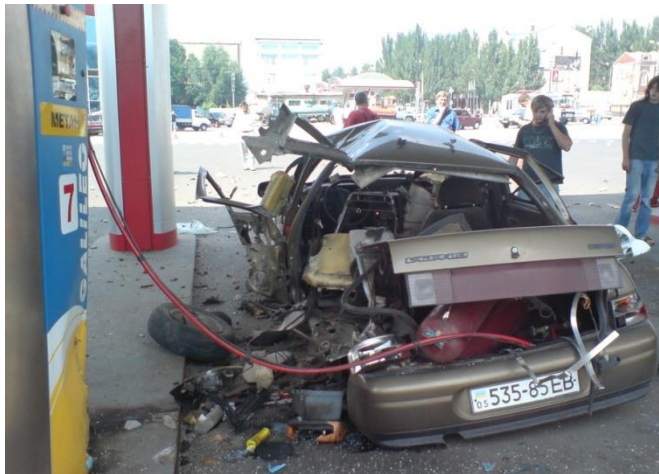
Рисунок 2 – Последствия взрыва баллона с метаном на заправочной станции
