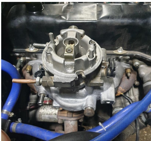
Рисунок 1 – Монтаж впускного коллектора и агрегата моновпрыска GM на ВАЗ-2103
