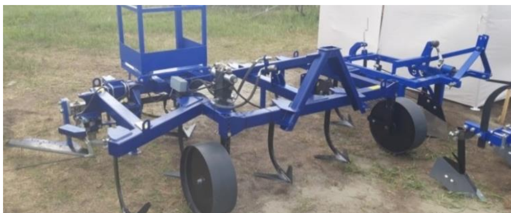
Рисунок 3 – Культиватор КДС-3,0: а – электронная 3D-модель с роторным рабочим органом; б – опытный образец с полольной лапой и модулем оператора
