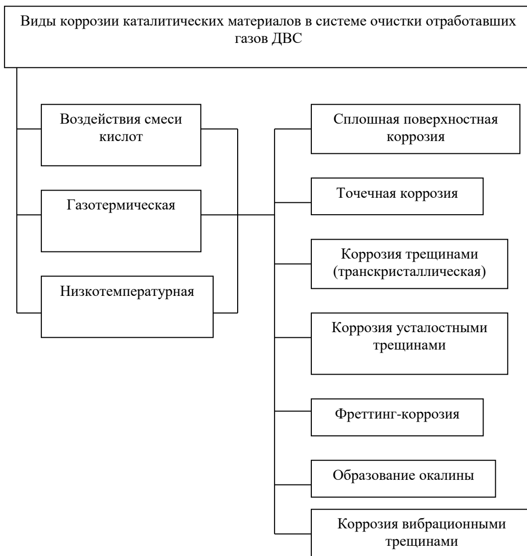
Рисунок 1 - Виды коррозии пористых проницаемых каталитических материалов по виду разрушений
