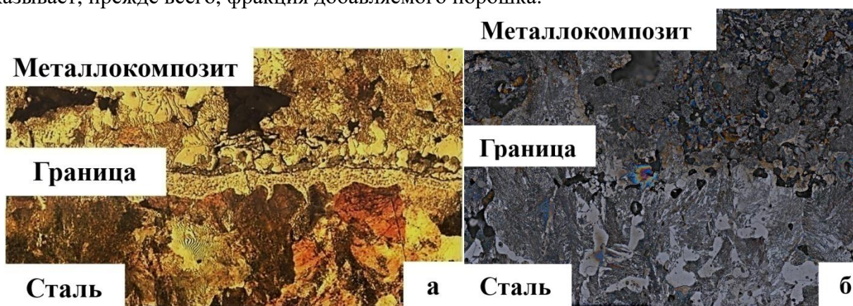
Рисунок 1 – Микроструктура припеченного металлокерамического брикета и стального основания без добавок микропорошков (а) и с добавками микропорошков (б)
