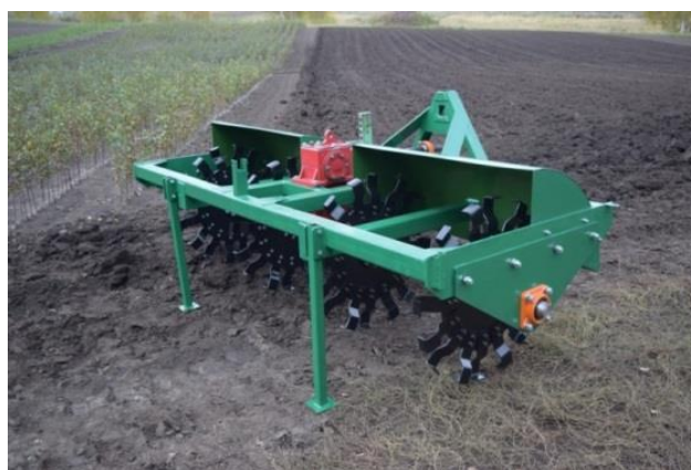
Рисунок 1 – Роторный щелеобразователь: а – электронная 3D-модель; б - опытный образец
