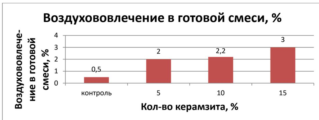
Рисунок 2 - Воздухововлечение в готовой смеси с заменой песка на керамзит
