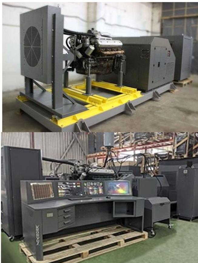
Рисунок 1 – Стенд для испытаний двигателя
