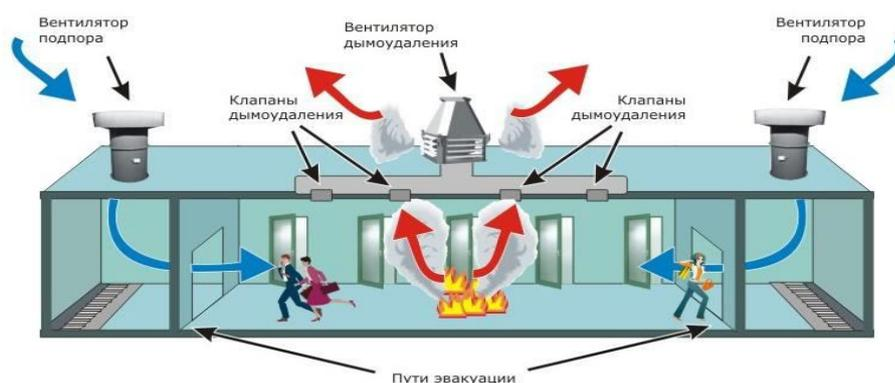
Рисунок 1 – Система пожаротушения и дымоудаления
