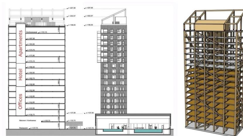
Рисунок 1 – Разрез и каркас высотного здания «Мьёсторнет», г. Брумундал, Норвегии
