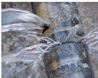
Рисунок 1 – Порыв воды в трубопроводе
