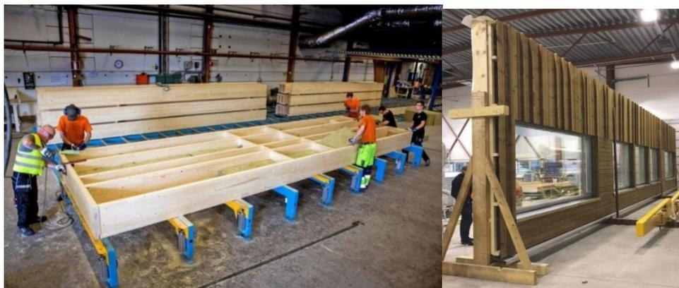
Рисунок 2 – Сборка на заводе междуэтажных перекрытий и стеновых панелей
