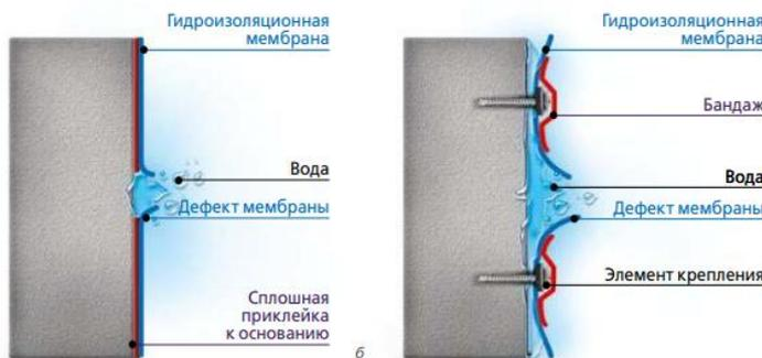
Рисунок 1 - Влияние дефекта кровельного ковра на характер распространения воды при различных видах монтажа
