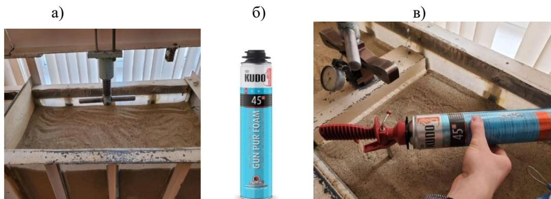
Рисунок 2 - Малый грунтовый лоток (а); б) баллон с монтажной пеной; в) подача монтажной пены в грунтовое основание
