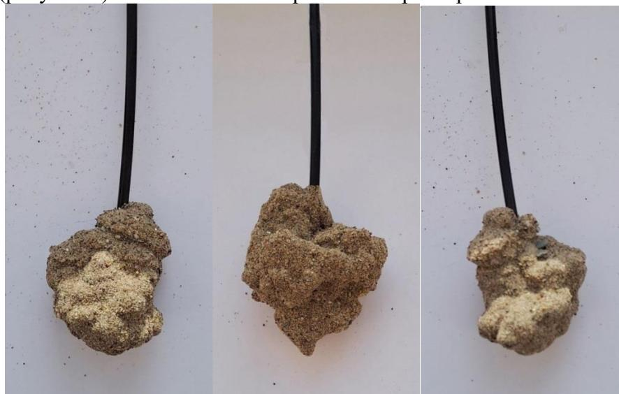
Рисунок 3 - Инъекционные тела, образованные в ходе лабораторных экспериментов
