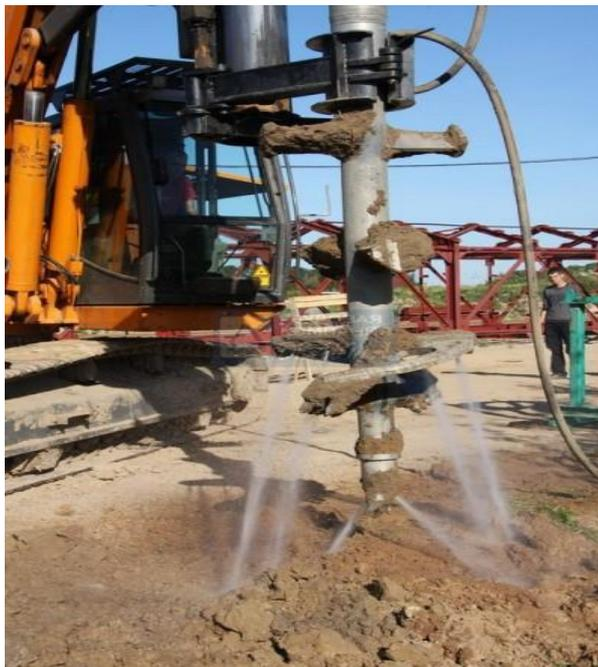
Рисунок 2 - Породоразрушающий инструмент диаметром 800 мм
