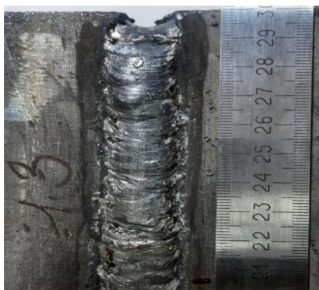
Figure 1 – A weld made by manual arc welding Рисунок 1 – Сварной шов, выполненный ручной дуговой сваркой
