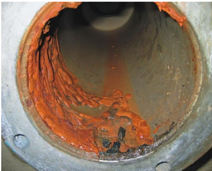
Рисунок 1 – Пример коррозии внутренней поверхности трубопровода
