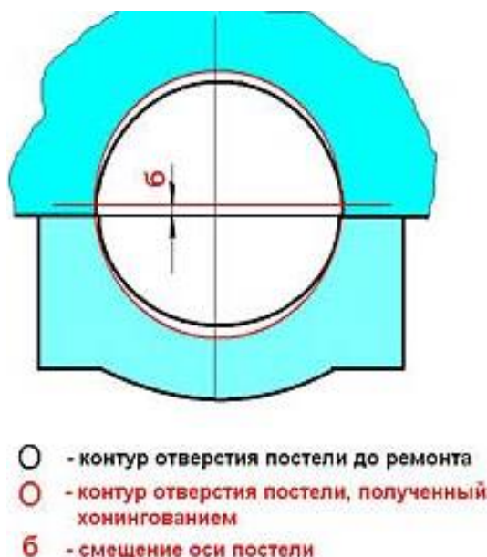
Рисунок 2 – Износ постели и крышки распределительного вала
