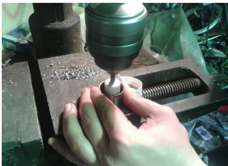
Рисунок 5 – Фрезеровка внутренней рабочей поверхности толкателя
