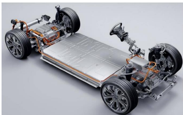
Рисунок 1 – Силовой блок электромобиля
