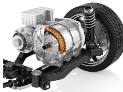
Рисунок 2 – Тяговые электродвигатели электромобиля
