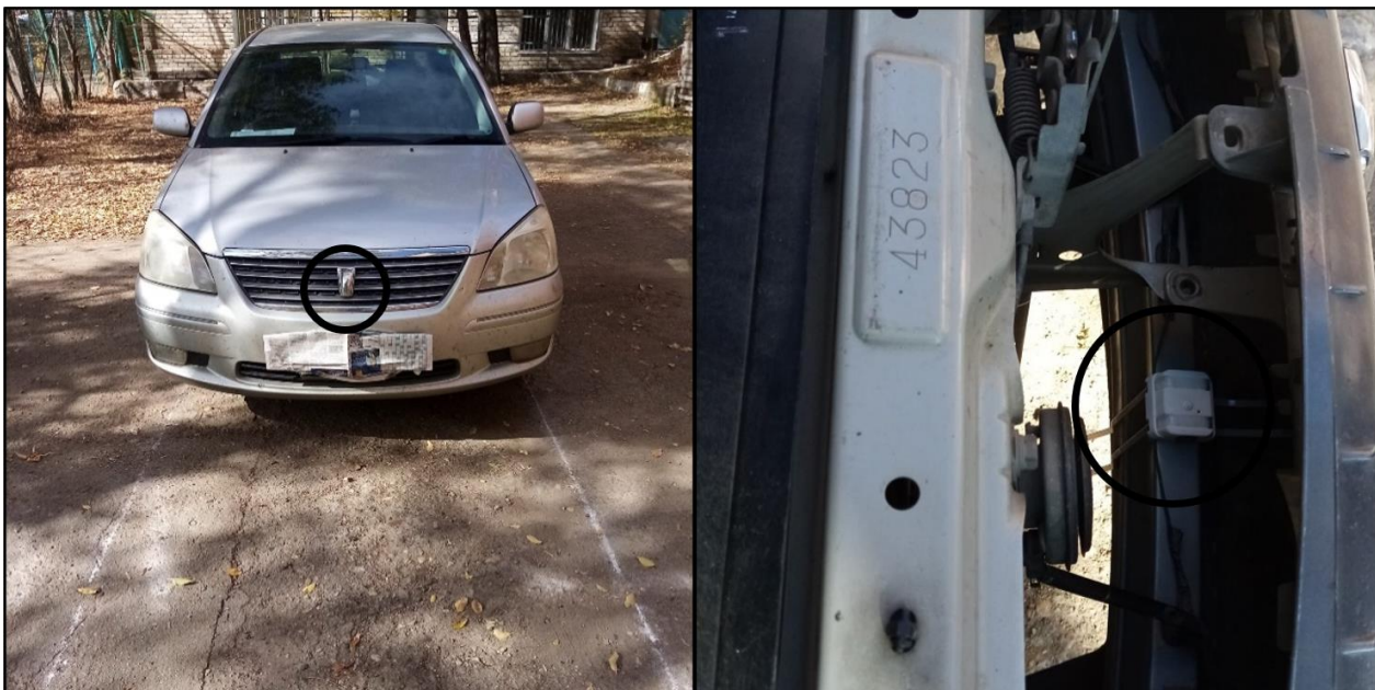
Рисунок 1 – Исследуемый автомобиль и место установки датчика приборного комплекса
