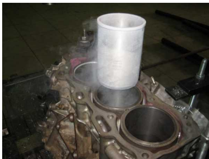
Рисунок 1 – Обеспечение разности температур блока и гильзы
