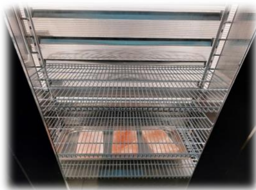
Рисунок 5 – Размещение гималайской соли в камере сухого созревания «dry-aging»
