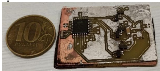
Рисунок 2 – Собственная уменьшенная плата для управления бесколлекторным двигателем
