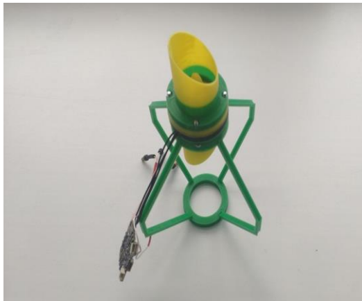
Рисунок 1 – Стенд для тестирования тягового усилия системы
