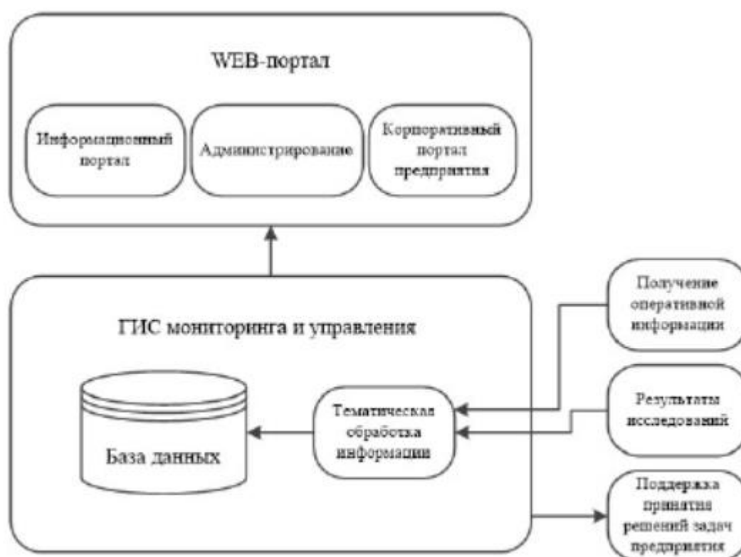
Рисунок 2 — Структура взаимодействия модулей информационной системы мониторинга и управления данными предприятия
