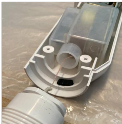
Рисунок - Аппарат с установленной изоляцией для уменьшения токов утечки
