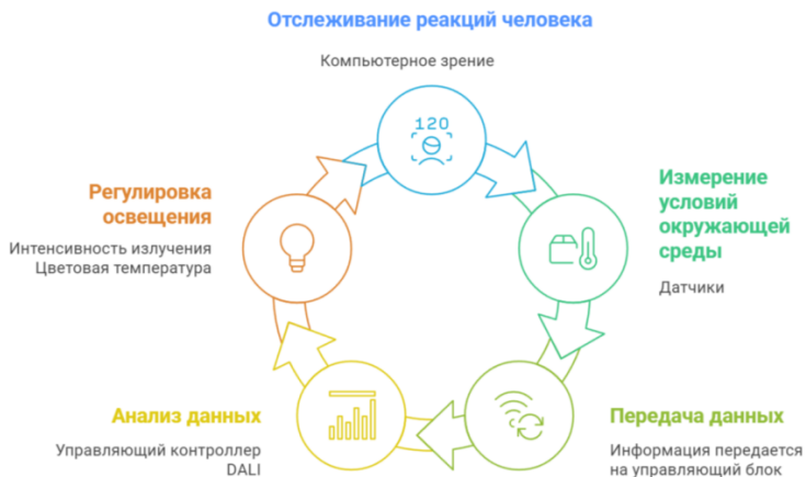
Рисунок 1 – Принцип действия системы освещения
