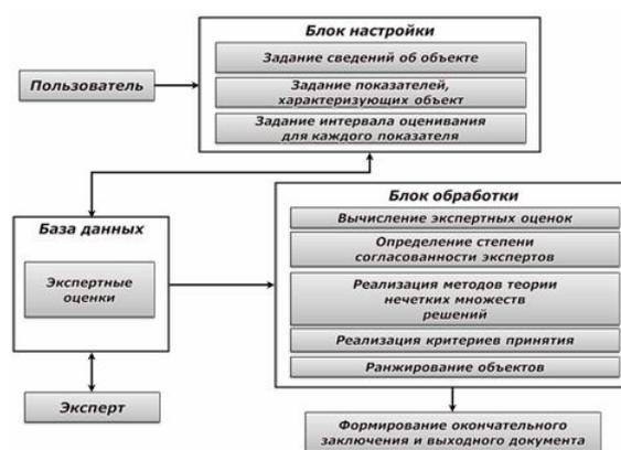
Рисунок 2 – Структурная схема программы, реализующей экспертную оценку
