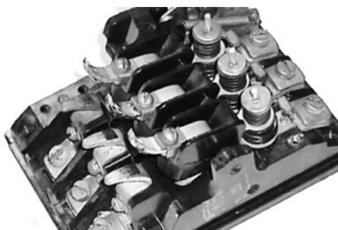
Рисунок 1 – Автоматический выключатель
