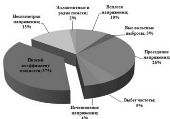
Рисунок 1 – Доли в общей сумме материальных потерь вызванных отклонением параметров качества электроэнергии
