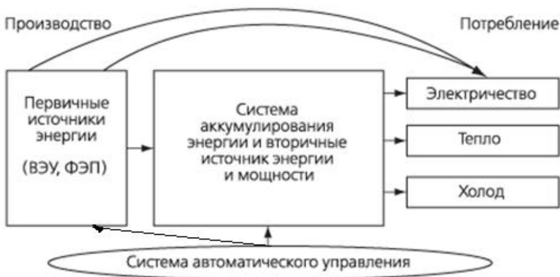
Рисунок 1 – Основные компоненты автономной энергоустановки на ВИЭ
