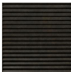
Рисунок 2 – Пирамидальная поверхность абсорбера в одной плоскости (клиновидный)
