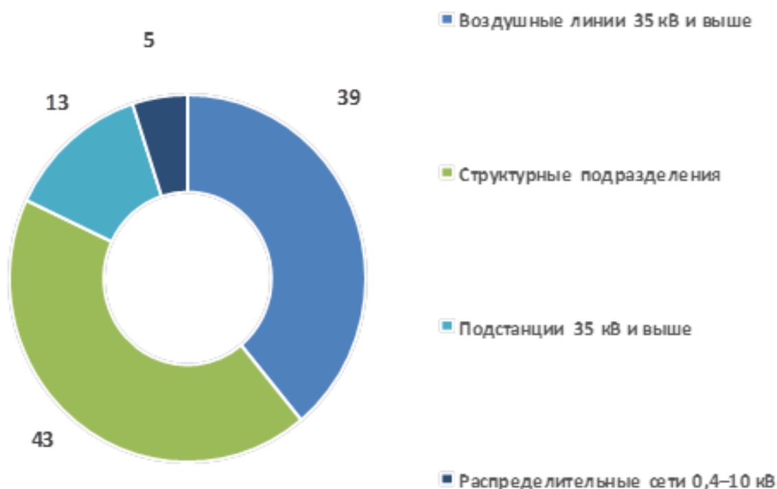
Рисунок 1 – Распределение технологических нарушений электросетевого комплекса
