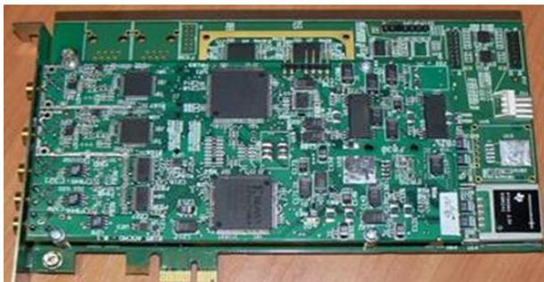
Рисунок 2 – Устройство для регистрации и цифровой обработки аналоговых сигналов ADC-DAC-125\_14
