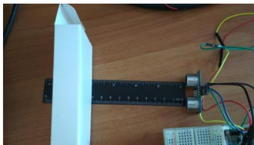
Рисунок 3 – Проверка корректности работы датчика
