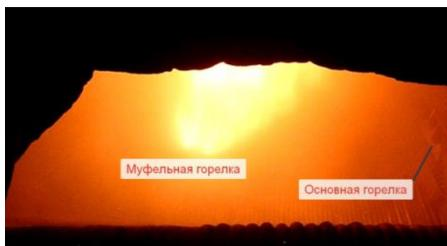
Рисунок 10 – Распространение факела муфельной горелки в топку котла ТП-10
