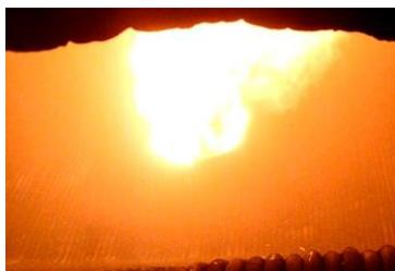
Рисунок 11 – Работа муфельной горелки при растопке котла ТП-10 из холодного состояния
