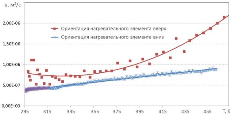
Рисунок 2 – Аналитическая зависимость коэффициента теплоотдачи ( $\text{м}^2/\text{с}$ ) от температуры (К)
