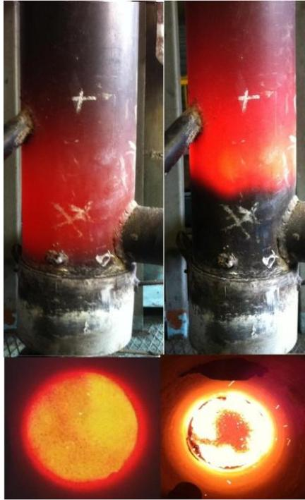
Рисунок 12 – Распространение поля температур на стенках камеры сгорания огневого стенда (слева – слой без содержания крупных частиц в нём, справа зашлакованный слой)
