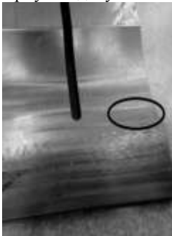
Рисунок 1 – УЗ сварочный инструмент с трещиной в зоне максимальных механических напряжений
