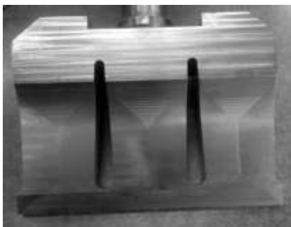
Рисунок 10 – Ультразвуковой сварочный инструмент для формирования продольных швов
