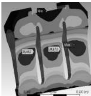
Рисунок 9 – Распределение механических напряжений оптимизированного УЗ сварочного инструмента
