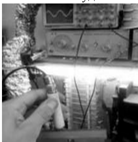
Рисунок 11 – Стенд для контроля амплитуды колебаний: 1 – осциллограф; 2 – генератор; 3 – ультразвуковой сварочный инструмент; 4 – пьезоэлектрический щуп
