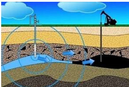
Рисунок 1 – Обводнение нефтяного пласта с целью поддержания давления
