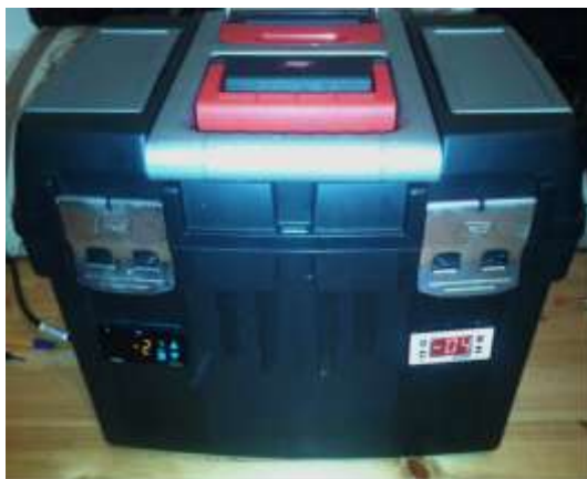
Рисунок 1 – Внешний вид термоэлектрического холодильника для хранения и перевозки биологического материала
