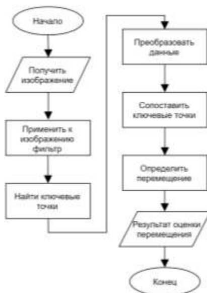
Рисунок 2 – Алгоритм определения перемещения методом визуальной одометрии
