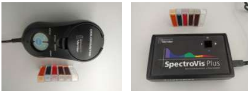
Рисунок 1 – Внешний вид датчика оптической плотности (слева) и спектрофотометра (справа)
