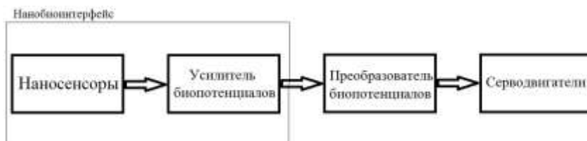
Рисунок 1 – Структурная схема нанобиоинтерфейса для протеза кисти руки
