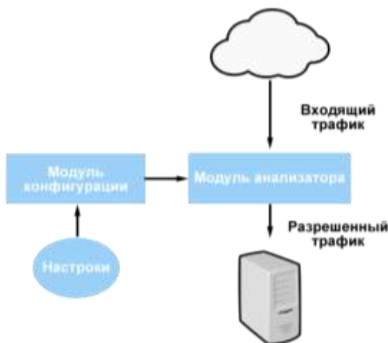
Рисунок 1 – Архитектура разработанного брандмауэра
