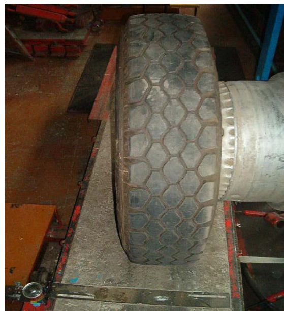
Рис.5. Опорная плита с приспособлением для определения проскальзывания протектора относительно опорной поверхности
