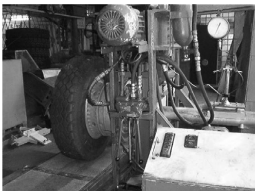
Рис. 4. Стенд для испытаний пневматических шин
