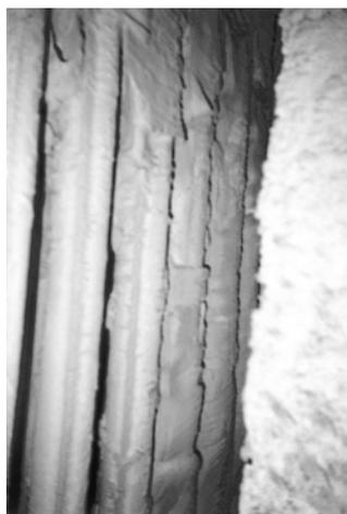
Рис.6. Отложения в 1-м котельном пучке котла КЕ-10-14 ОГВ при сжигании подсолнечной лузги
