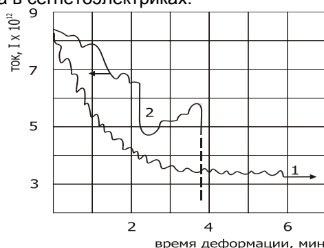
Рис. 1. Изменение темновой проводимости НК \beta -азида свинца и азида серебра при деформации: 1 – НК \beta -азида свинца, скорость деформации 3 \cdot 10^{-6} Н/с; 2 – НК азида серебра, скорость деформации
