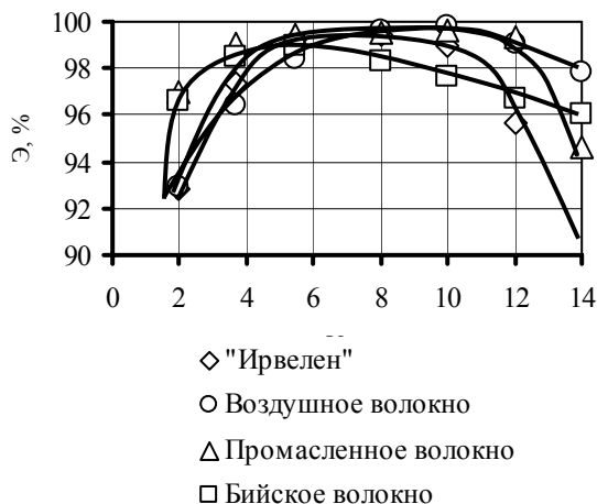
Рис. 2. Зависимость изменения эффективности очистки (Э) от пропущенного объема (V) при плотности укладки 100 \text{ кг/м}^3
