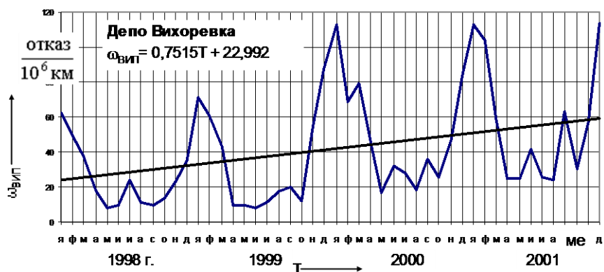
Рис. 4. Динамика изменения показателя безотказности выпрямительно-инверторных преобразователей ВИП-4000 электровозов ВЛ85
