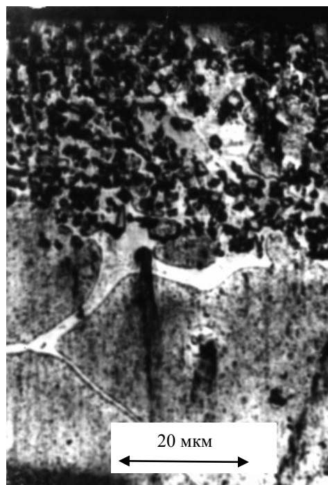
Рисунок 3 – Поперечный шлиф покрытия на основе порошковой смеси WC-Co(BK15)+2%B после жидкофазного спекания на подложке из стали У10
