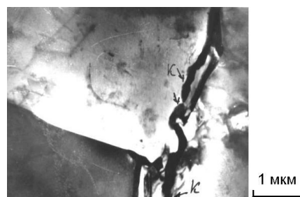
Рисунок 1 – Электронно-микроскопическое изображение тонкой структуры борированной стали 08кп П – перлитная колония: пластины цементита (Ц) и феррита (Ф); К – прослойки цементита по границам зерен " \alpha -фаза - цементит"
