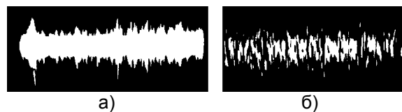
Рисунок 7 – Осциллограмма, начала, развития (а) и самого процесса (б) заедания
